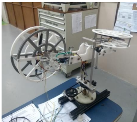
Figura 32: Imagem do modelo físico do helicóptero de dois graus de liberdade construído no PPGEE UFAM. (Próprio Autor)
