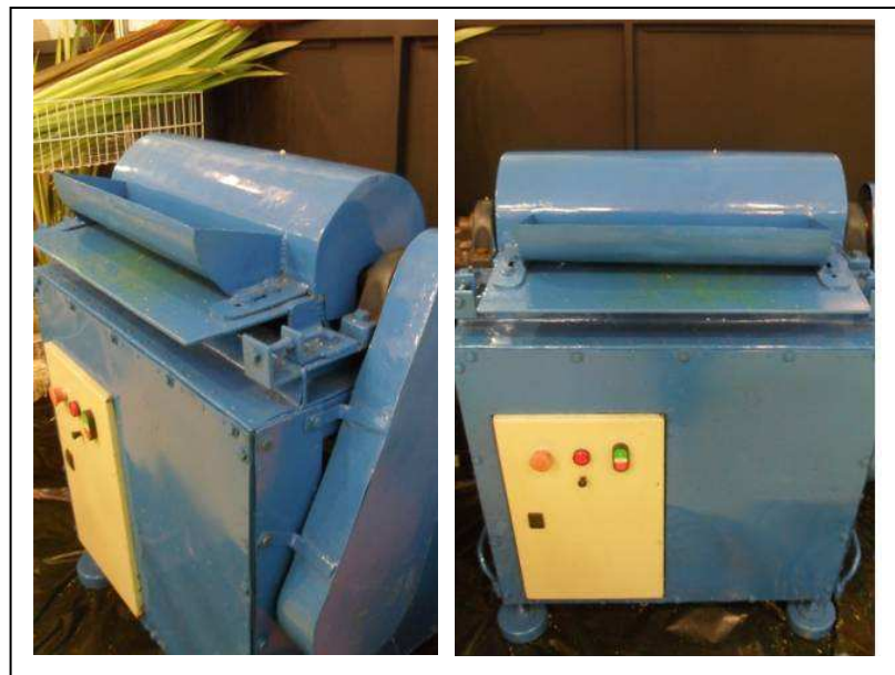
Figura 13 – Máquina de Desfibrar, tipo “Tapuia”. FONTE: Foto Jéssica Maciel (2009).
