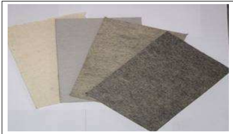
Figura 12 – Mantas agulhas produzidas a partir da fibra do Curauá. FONTE: Site da Empresa Monopsonista (2009).
