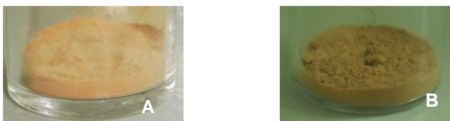
Figura 27: Aspecto macroscópico do PSA antes da exposição a 65% de umidade relativa (A), e após 15 dias de exposição (B).
