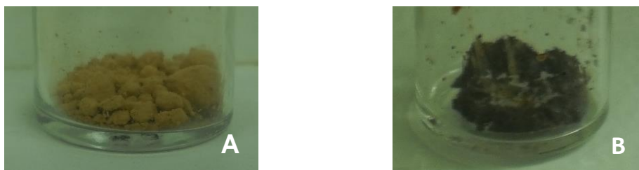
Figura 26: Aspecto macroscópico do ESA antes da exposição a 65% de umidade relativa (A), e após 15 dias de exposição (B).
