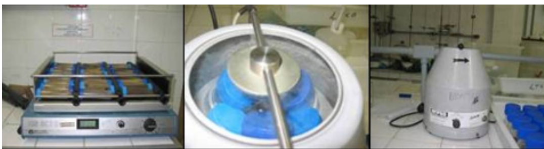
Figura 7. Agitação e centrifugação das amostras no processo de fracionamento do Fósforo.
