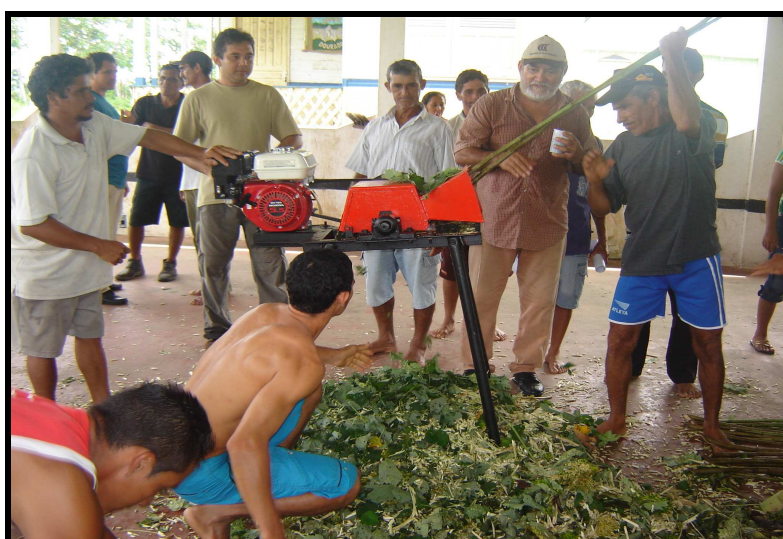
Figura 7 – Treinamento com os agricultores do uso da Máquina descortçadora de malva/juta FONTE: NUSEC/FCA/UFAM (2007).
