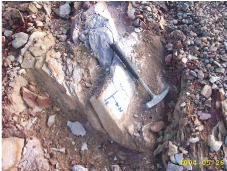
Figura 10: Camadas de litarenito com mergulho de 30° para NW.
