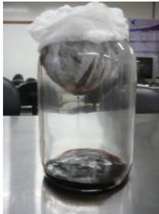
Figura 12 - Filtração do licor de açáí
