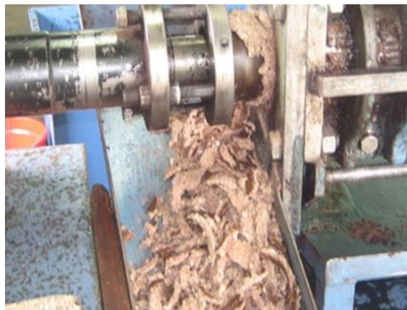
FIGURA 14: Torta de resíduo de Andiroba, utilizado na mistura de adubo orgânico na usina. Fonte: Relatório de produção de 2010 da Coopfitos.
