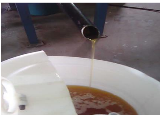
FIGURA 15 - Óleo de Andiroba escorrendo pelo funil da prensa para o recipiente.
