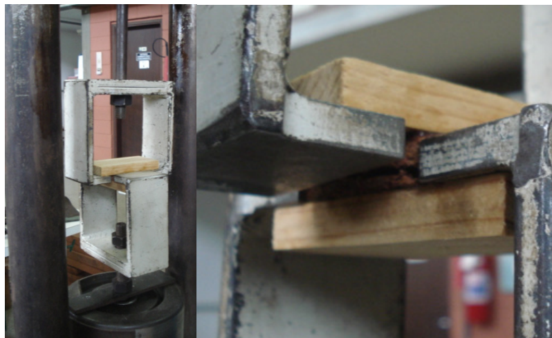
Figura 34: Corpos-de-prova (a) antes; (b) Durante o ensaio, corpo-de-prova se rompendo.
