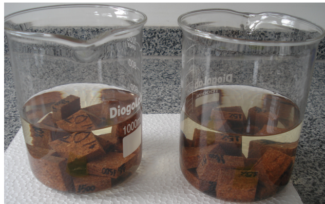
Figura 32: Corpos-de-prova de Amapá e Cumaru imersos em água para testes de absorção e inchamento, respectivamente.
