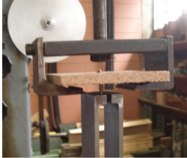
Figura 35: Corpo-de-prova de Amapá em ensaio de arrancamento de parafuso.
