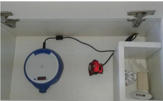
Figura 22 – Agitador magnético, webcam e fonte de luz no interior da caixa branca.
