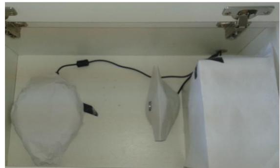
Figura 23 – Uso de papel branco para eliminar as interferências de cores dos equipamentos.
