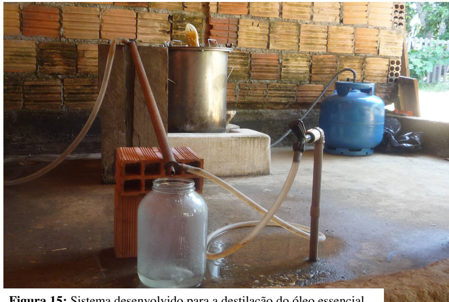
Figura 15: Sistema desenvolvido para a destilação do óleo essencial Fonte: Lilia Mendonça, Silves, 2009
