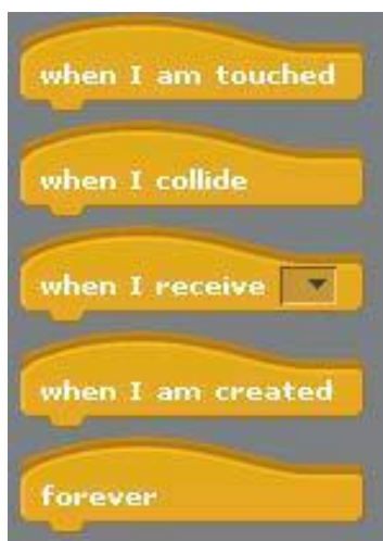
Figura 37: Bloco de inicialização do script no scratch4SL
