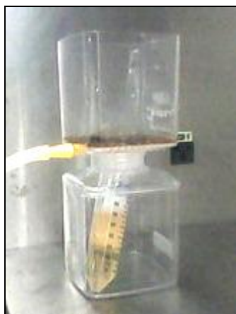
Figura 12: Sistema de filtração a vácuo com filtros de millipore de 0,22 \mu\text{m} .
