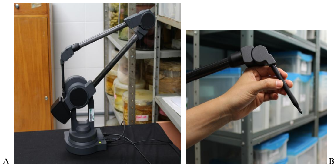
Figura 6. A. Braço digitalizador MicroScribe® 3D. B. Ponteira pela qual os landmarks são marcados no crânio e obtidas as coordenadas.
