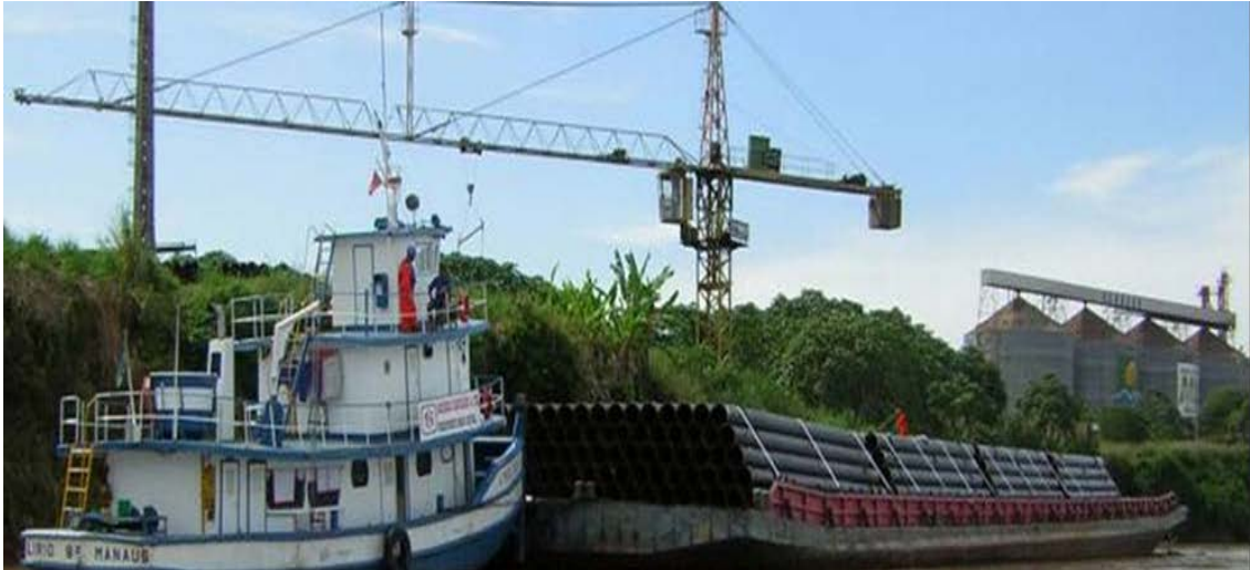
Figura 42. Empurrador LIRIO pertencente a SC Transportes, com 1 motor Man-B&W 6s50MC e capacidade de 375 HP, o equivalente a 0,22371 MW de potência requerida pelo motor.
