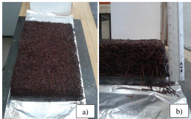
Figura 38 - Formação de colchão: a) Material após pré-prensagem, b) Registro de altura do material conformado.
