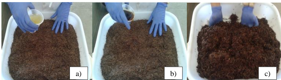
Figura 36 - Processamento da mistura: a) Adição do Poliól, b) Adição do Pré-polímero, c) Incorporação do adesivo (mistura).
