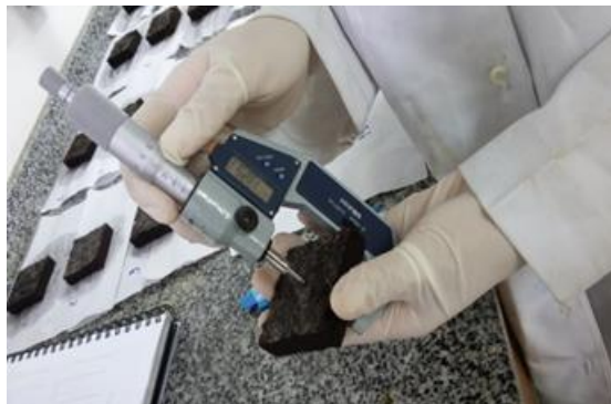
Figura 49 - Verificação de espessura após 24 horas.
