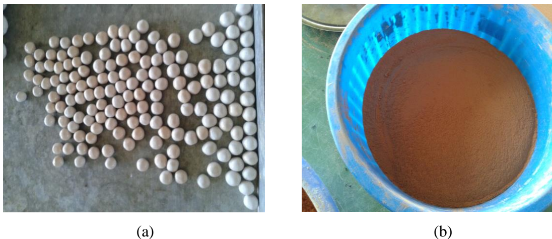
Figura 3.4 (a) Esferas para moinho de bolas e (b) Resíduo moído nº 100 (0,150 mm).
