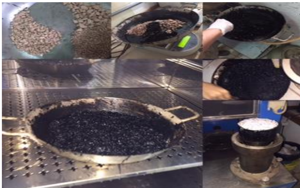
Figura 22: Preparo Corpo de Prova de Concreto Asfáltico com ASAC
