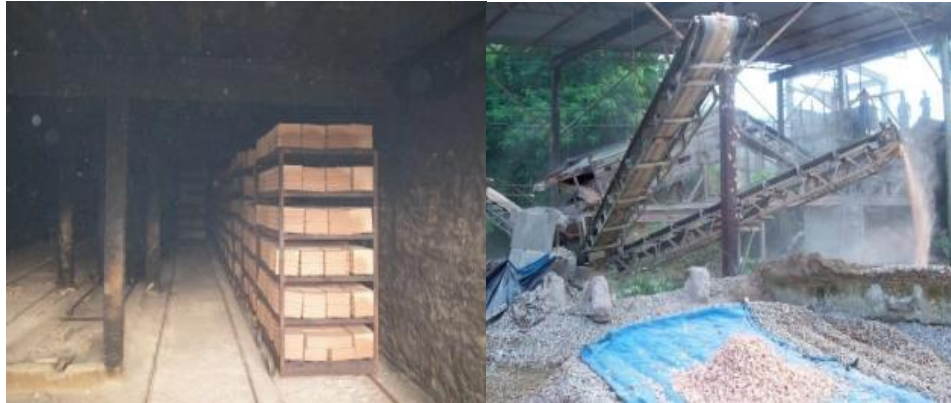
Figura 15- Secagem dos tijolos em sistema de túnel (direita) / ASAC obtido após britagem (esquerda)
