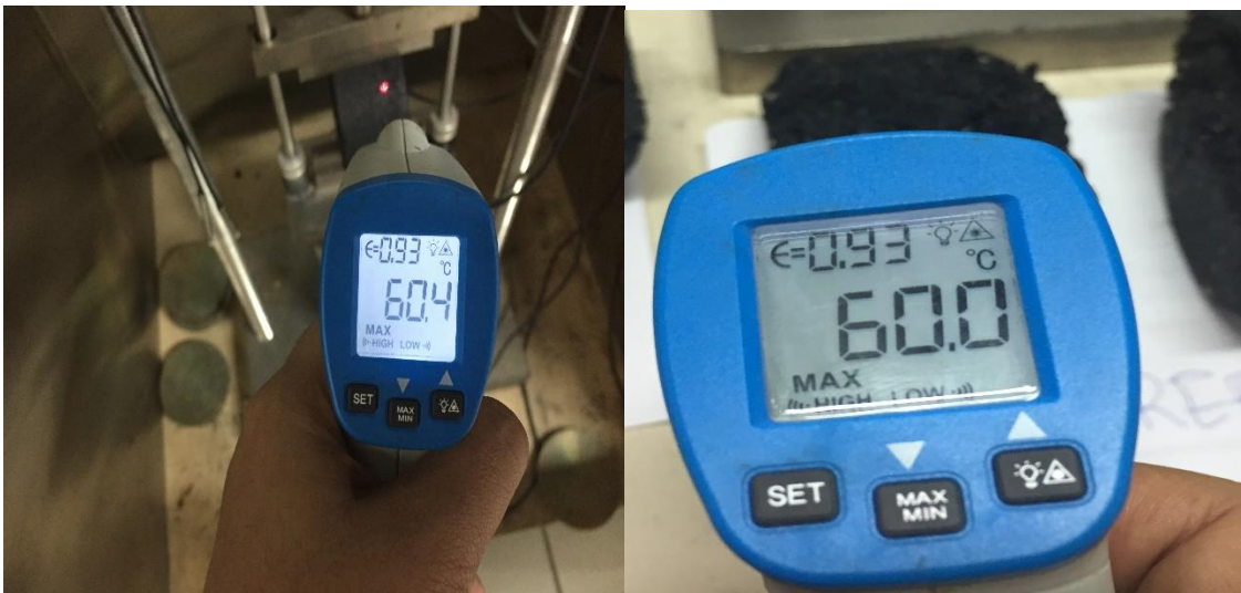
Figura 33: Ensaio de Resistência à Tração à 60°C (esquerda) / Após ensaio de Resistência à Tração à 60°C
