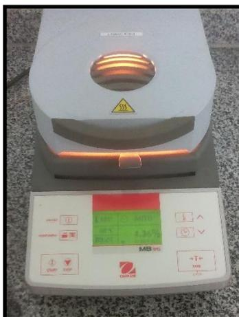
Figura 15: Analisador de umidade MB 35.
