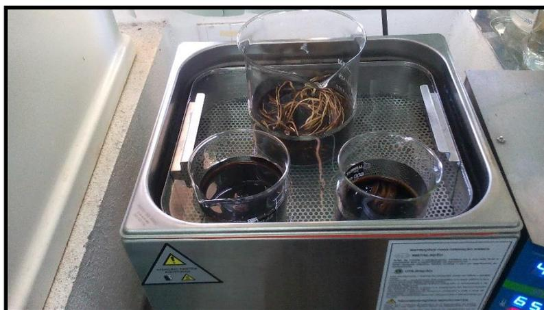
Figura 13: Impregnação do lignosulfonato de sódio nas fibras em banho de ultrassom.
