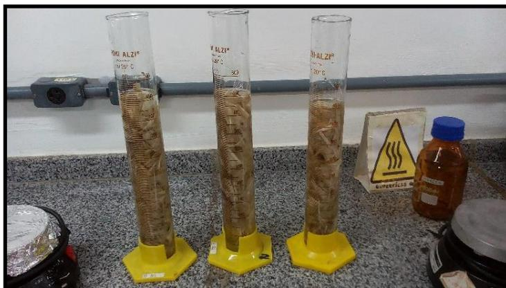
Figura 14: Ensaio para determinação de densidade volumétrica com uso de proveta graduada.
