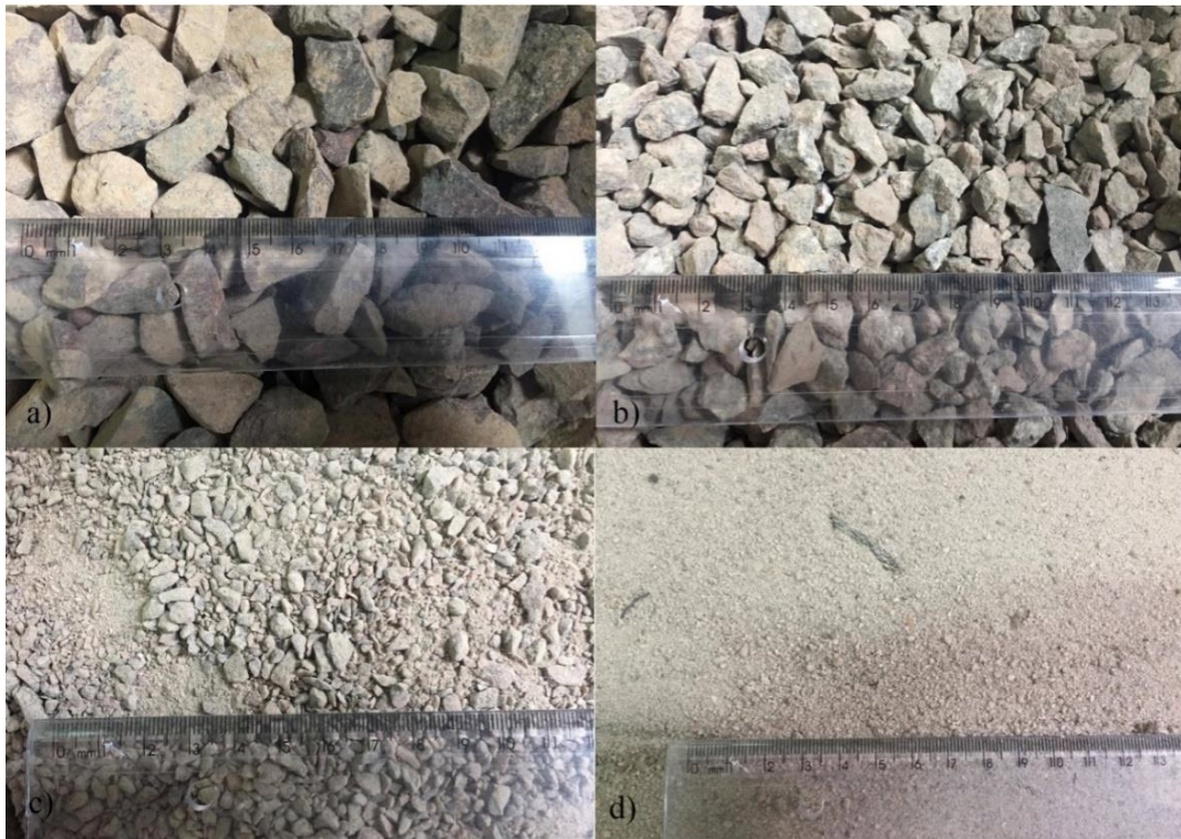
Figura 23 – Materiais utilizados na pesquisa: a) brita 1; b) brita 0; c) pó de pedra; e d) areia residual.
