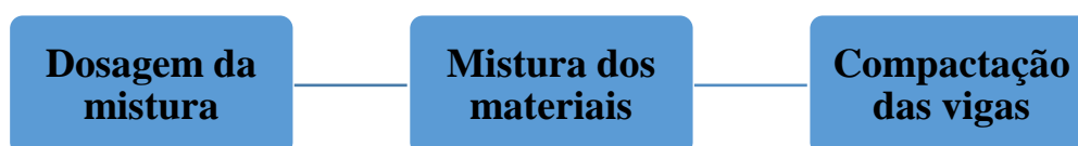
Figura 30 – Fluxograma da moldagem de vigas asfálticas.
