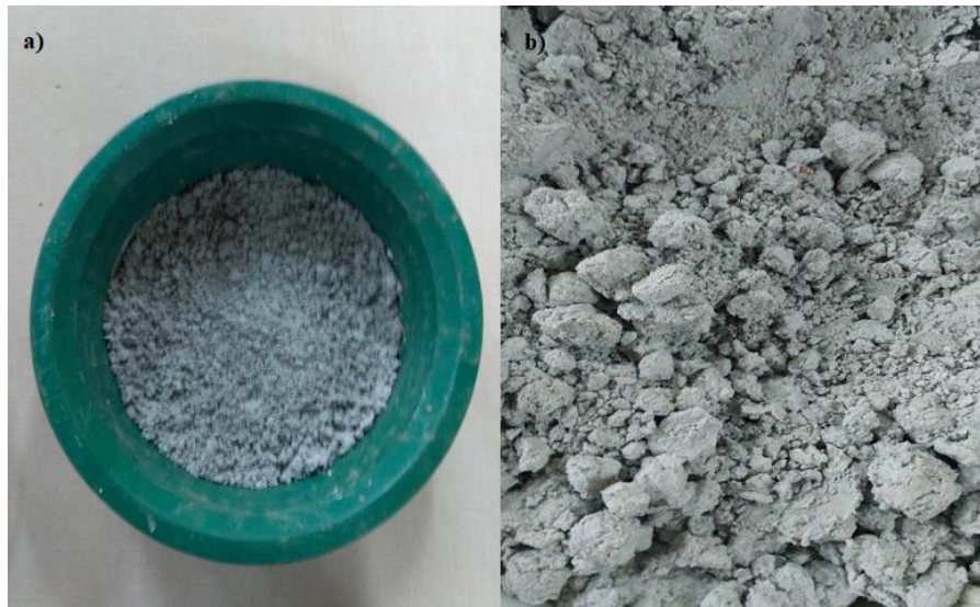
Figura 21 – a) Cal de carbureto; b) Detalhe da textura da cal.
