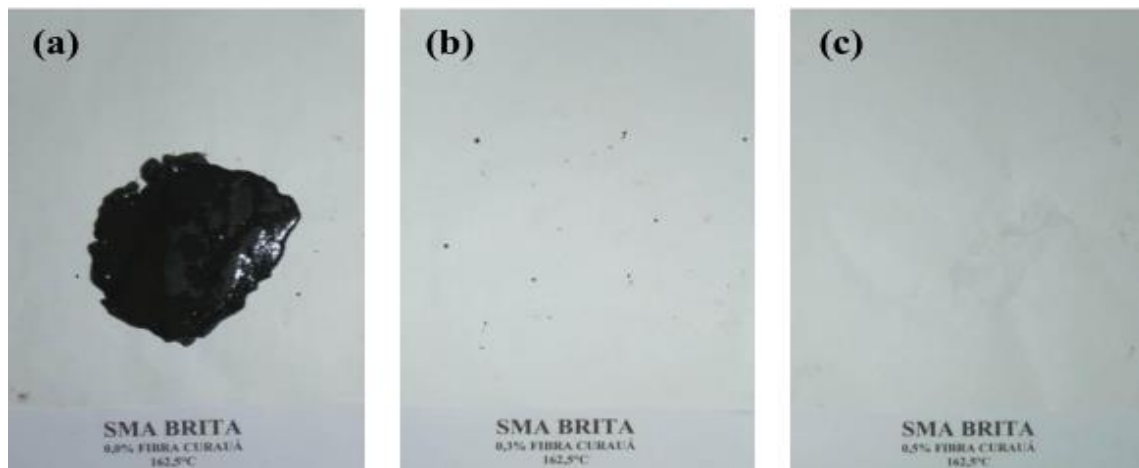
Figura 12 – Ensaio de Escorrimento de Mistura SMA a 162,5°C: (a) 0%, (b) 0,3% e (c) 0,5% de fibra do curauá.
