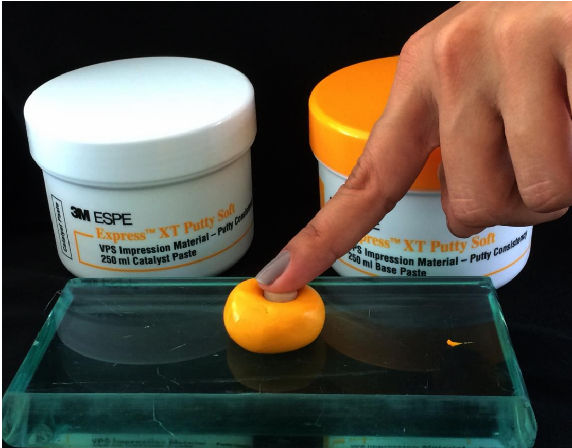
Figura 5: Inserção do corpo de prova modelo para confecção do molde
