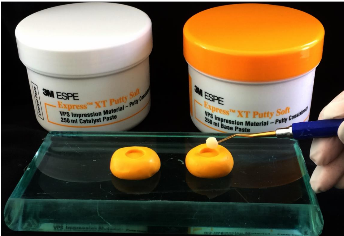
Figura 6: Inserção da resina para confecção dos corpos de prova
