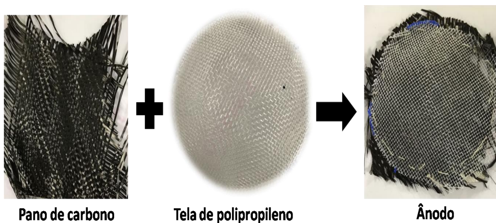
Figura 16: Montagem do ânodo.
