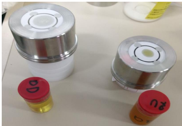
Figura 24: Célula para análise de metais junto ao papel de celulose contendo as amostras de óleo doméstico e do RU.
