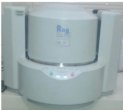
Figura 12. Equipamento de Fluorescência de Raios X Shimadzu (modelo Ray Ny EDX-720).
