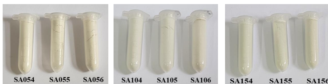
Figura 21. Amostras de superácidos obtidas a partir da mistura de SFT e NSH, calcinadas a diferentes temperaturas.
