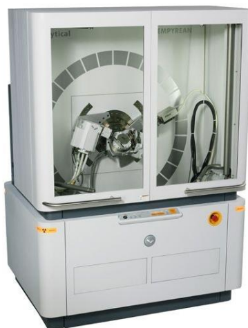
Figura 15. Difratômetro de raios X da PANalytical (modelo XRD-empyrean) .
