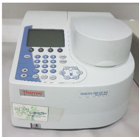
Figura 20. Espectrofotômetro de UV-vis da Thermo Scientific TM (modelo GENESYS 10S).
