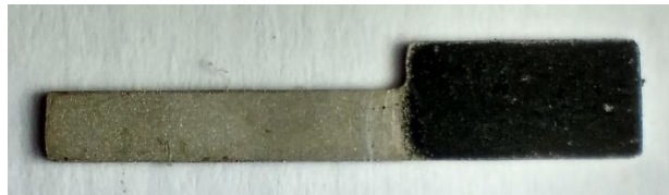
Figura 4.3 – Eletrodo produzido pelo processo de pincelamento
