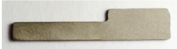
Figura 4.2 - Substrato de aço inoxidável após o processo de limpeza
