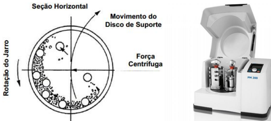
Figura 2.1: (a) Esquerdo diagrama esquemático do movimento dos corpos moedores em um moinho planetário (Suryanarayana, 2001). (b) Direita imagem de um moinho vibratório PM 200.
