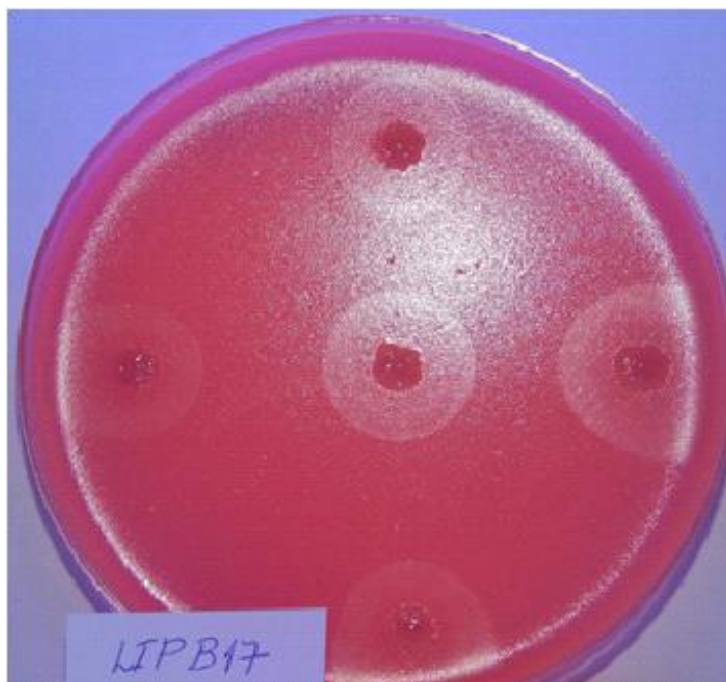
Figura 13- Formação do halo ao redor das colônias de isolados bacterianos indicando a ação da lipase em meio contendo óleo de inajá como substrato.
