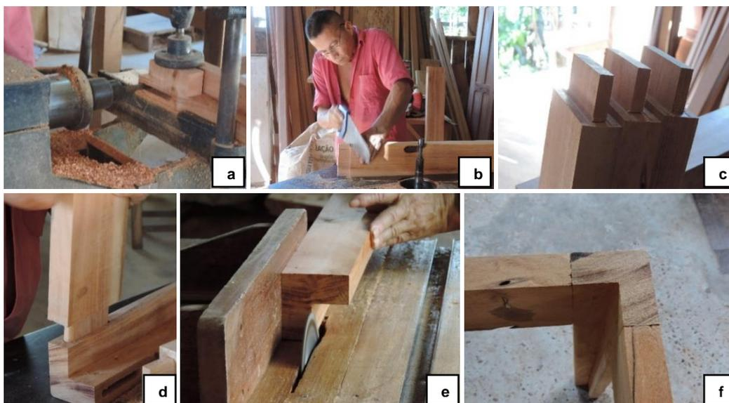
**Figura 33.** a. furadeira horizontal para ligação espiga; b. serra de mão para realização da ligação espiga; c. estrutura da peça de madeira para o encaixe da ligação espiga; d. encaixe entre as ligações; e. perna da mesa em formato L; f. ligações entre a perna e o esquadro da mesa. **Fonte:** Próprio Autor.
