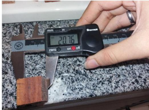
**Figura 23.** Aferição das dimensões da amostra de madeira para as superfícies radiais e tangenciais. **Fonte:** Próprio Autor.
