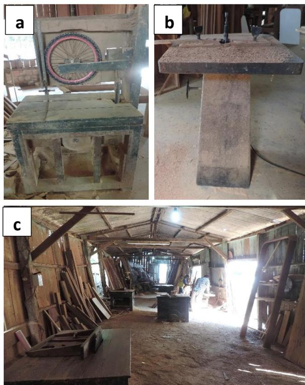
**Figura 24.** a. Serra fita. b. Máquina de Tupia. c. Visualização da serraria de pequeno porte.
