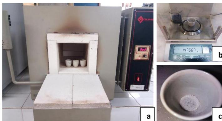
**Figura 14.** a. Cadinhos de porcelana postas na mufla à 600 °C. b. Pesagem da amostra até a obtenção do peso seco. c. Visualização da amostra após a total carbonização, em estado de cinza. **Fonte:** Próprio Autor.
