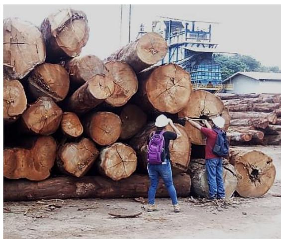
**Figura 4.** Medição dos diâmetros do oco das toras de madeira, no pátio da serraria. **Fonte:** Próprio Autor.
