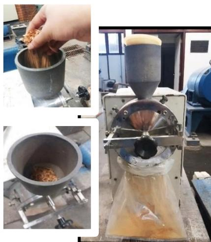
**Figura 13.** Partículas de madeiras obtidas após o desdobro das toras de madeira, colocadas no moinho para que fossem transformadas em serragem. **Fonte:** Próprio Autor.
