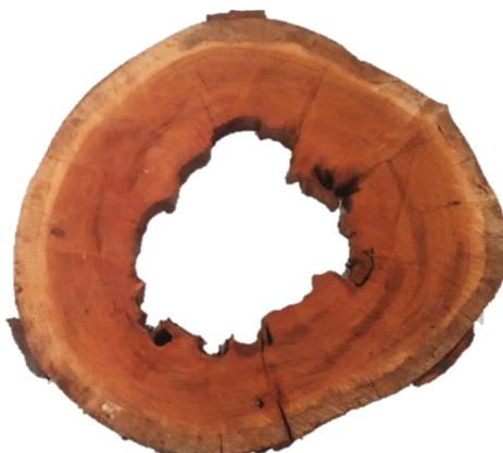
**Figura 10.** Disco de madeira com 10 centímetros de espessura, para identificação e caracterização anatômica, além de obtenção de propriedades químicas e físicas da madeira.
