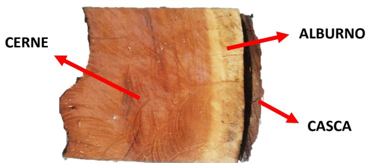
**Figura 11.** Amostra completa para a caracterização anatômica, química e física da madeira.
