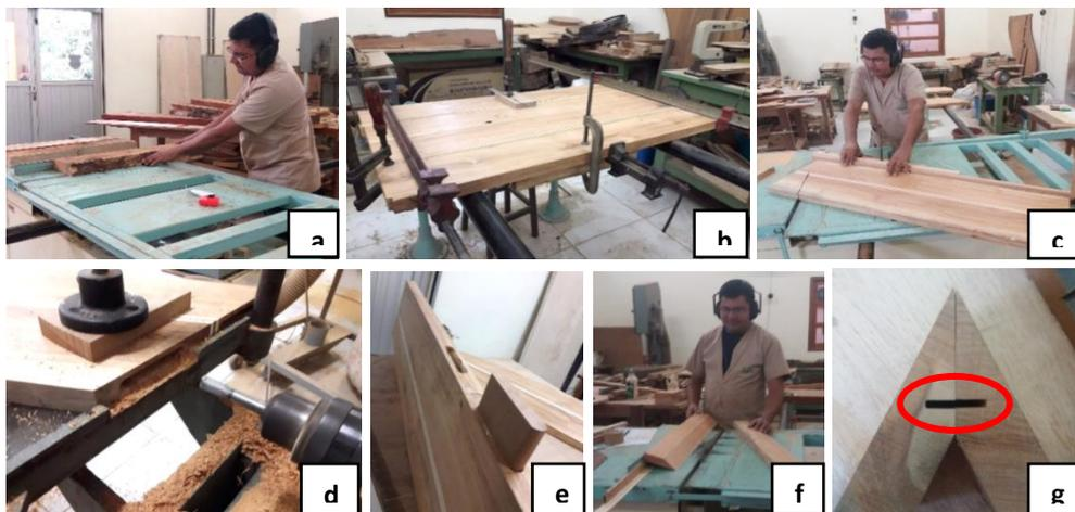
**Figura 40.** Processo de confecção da mesa. **a.** peças sendo processadas em serra circular. **b.** Colagem das peças de marchetaria para o tampo. **c.** peça do tampo sendo redimensionada, conforme medidas projetadas. **d.** furadeira horizontal realizando furo lateral para ligação das peças, **e-** ligações do tipo espiga, **f.** inclinação do corte nas peças da perna da mesa, **g.** ligação para junção entre as peças da perna da mesa. **Fonte:** Próprio Autor.
