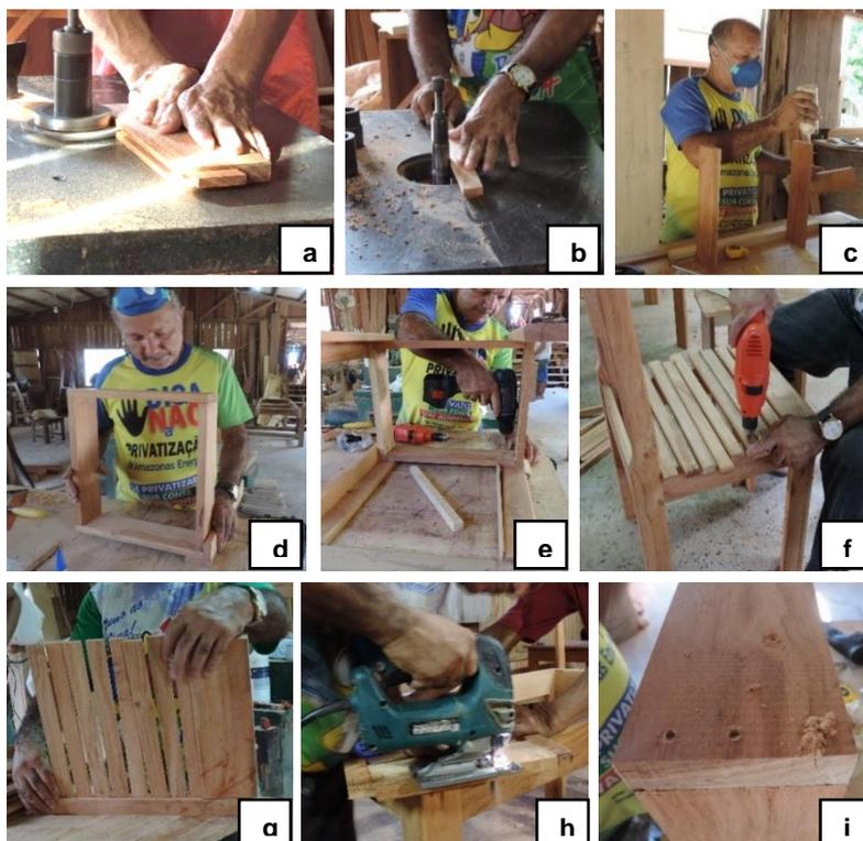
**Figura 35.** a. Tupia fazendo uma abertura de encaixe; b. fresa realizando o arredondamento da borda da peça; c. Utilização de adesivo PVA; d. confecção do aro; e. perfuração com furadeira elétrica para colocação do prego; f. perfuração com furadeira para colocação dos pregos nas ripas do assento; g. moldando o encosto da cadeira; h. curvatura da cadeira, feita com serra fita de mão, i- utilização de pó de serra coladas em cima da cabeça do prego. **Fonte:** Próprio Autor.
