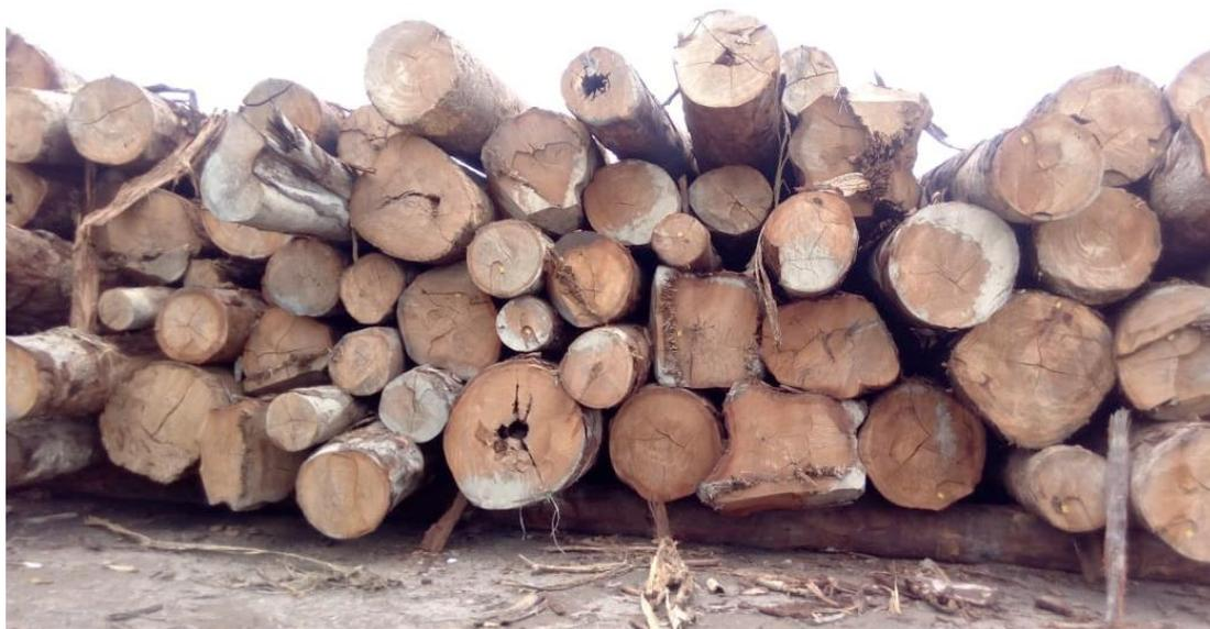
**Figura 2.** Levantamento de toras ocas no pátio da serraria da empresa. **Fonte:** Próprio Autor.
