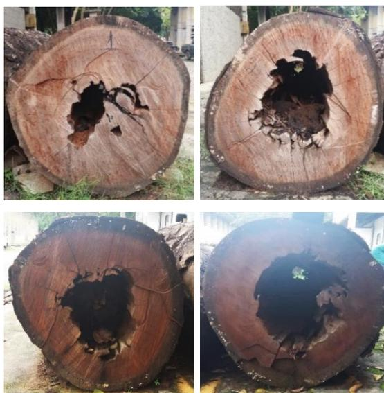
**Figura 28.** As extremidades das duas toras de madeira, demonstrando a mudança da coloração durante o seu tempo de armazenamento até o início do desdobro. **Fonte:** Próprio Autor.
