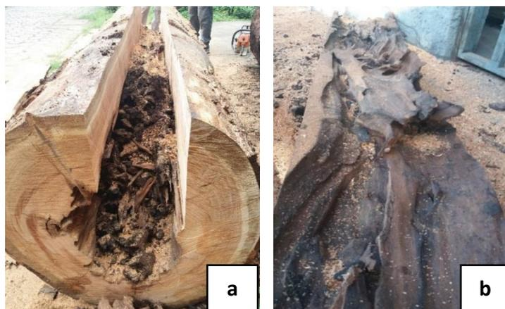
**Figura 29.** Ao retirar a(s) primeira(s) peça(s) do oco, destacaram-se o **a-** Material escurecido presente na cavidade das toras, e **b-** As estruturas desuniformes da madeira. **Fonte:** Próprio Autor.
