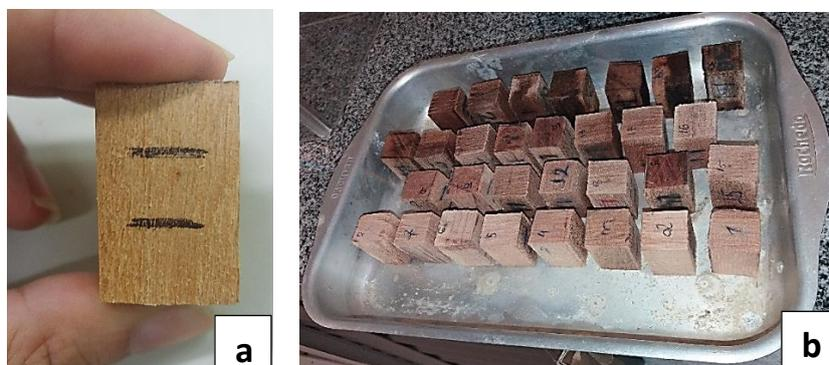
**Figura 21.** **a.** Amostras de madeira, com dimensões específicas superfície radial devidamente identificada, para serem determinadas algumas propriedades físicas da madeira. **b.** Todas as amostras devidamente identificadas por numeração. **Fonte:** Próprio Autor.
