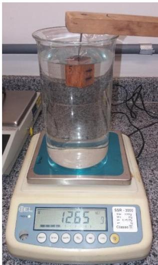
**Figura 22.** Determinação do volume da madeira pelo método de imersão. **Fonte:** Próprio Autor.
