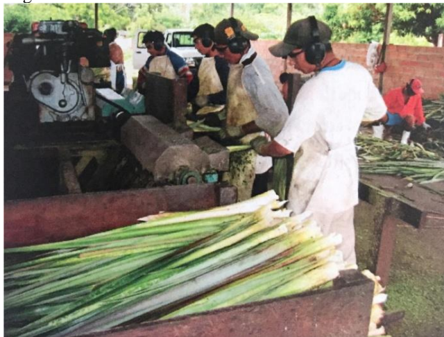
Figura 4 – Processo de desfibramento das folhas de curauá.
