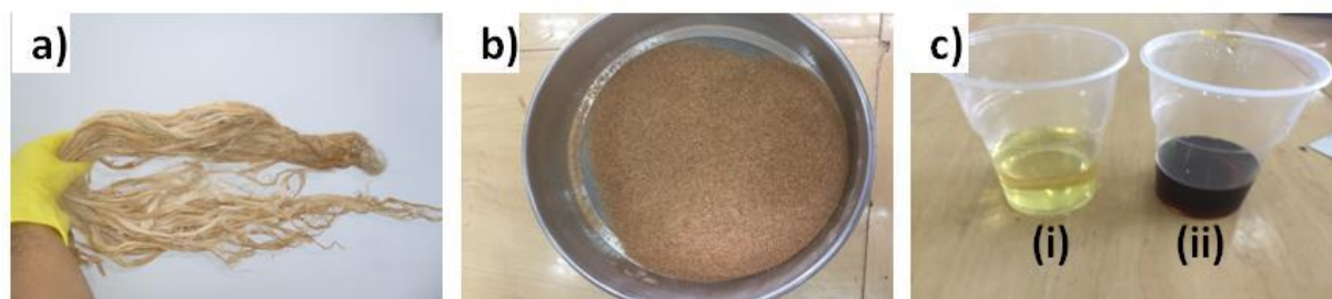
Figura 7 – Materiais: a) Fibra de curauá; b) Resíduos de madeira; c) Resina: (i) polioli e (ii) pré-polímero.
