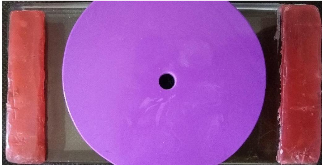
Figura 13. Aspecto final da matriz de silicone para obtenção dos espécimes de resina composta.
