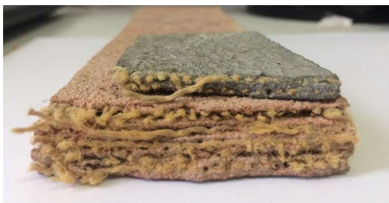
Figura 48. Amostra da composição da telha cimentícia reforçada com fibras naturais
