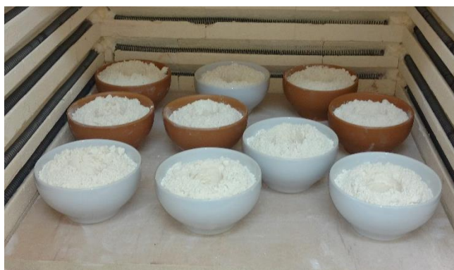
Figura 3.8 - Caulim no interior da mufla para calcinação.
