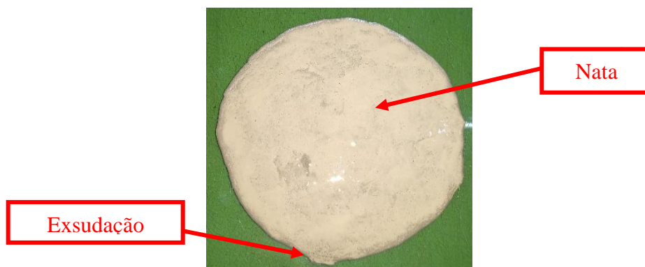
Figura 3.23 - Argamassa autonivelante com exsudação.
