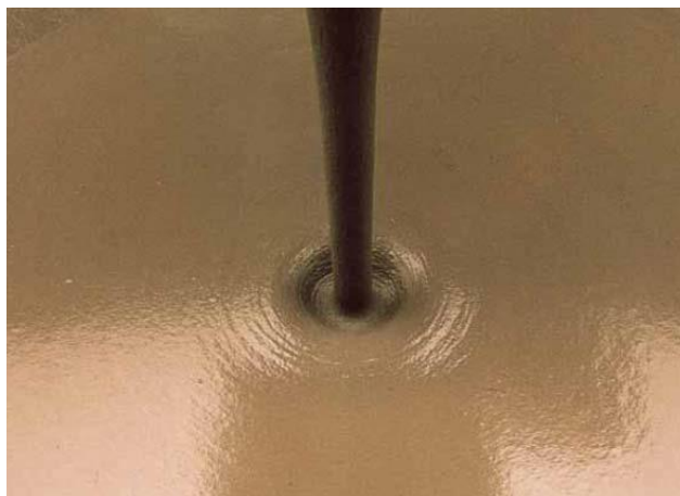
Figura 2.1 - Alta fluidez da argamassa autonivelante. Fonte: Martins, 2009.
