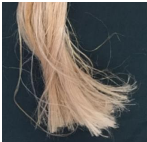
Figura 2.10 - Fibra de juta na forma de fio. Fonte: Portela, 2016.
