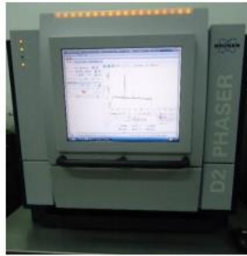
Figura 3.12 -Difratômetro Bruker D2 Phaser do Laboratório de Síntese e Caracterização de Nanomateriais do IFAM.
