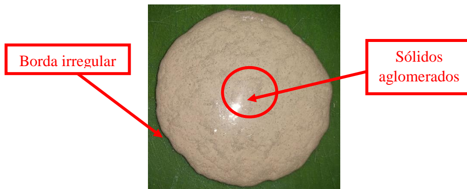
Figura 3.22 - Argamassa autonivelante com segregação.
