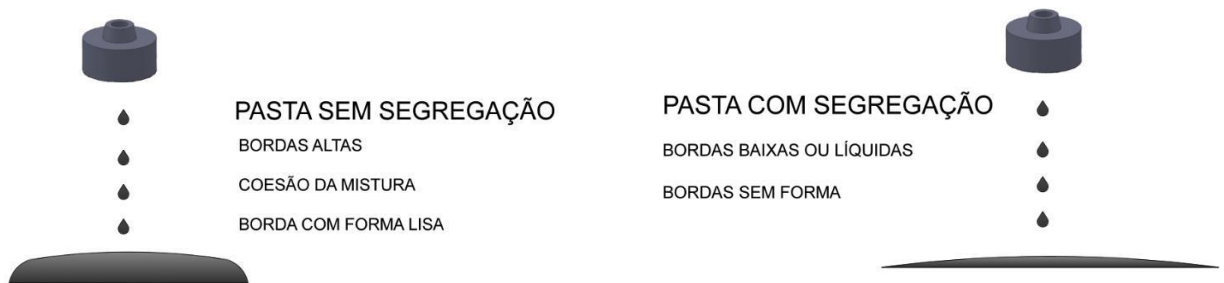
Figura 3.21 - Análise visual da argamassa escoada quanto à segregação. Fonte: Lopes da Silva, 2016.
