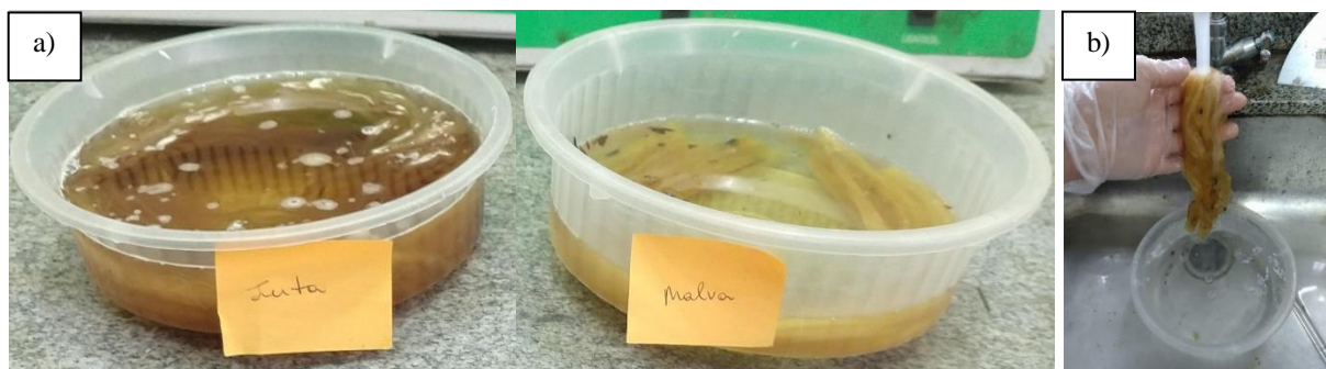
Figura 3.9 - Tratamento alcalino nas fibras naturais: a) Fibras de juta e malva imersas em solução alcalina; b) Lavagem das fibras.
