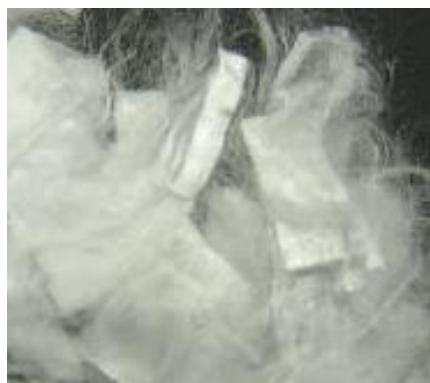
Figura 2.8 - Fibra de polipropileno. Fonte: Maccaferri do Brasil Ltda., 2008.
