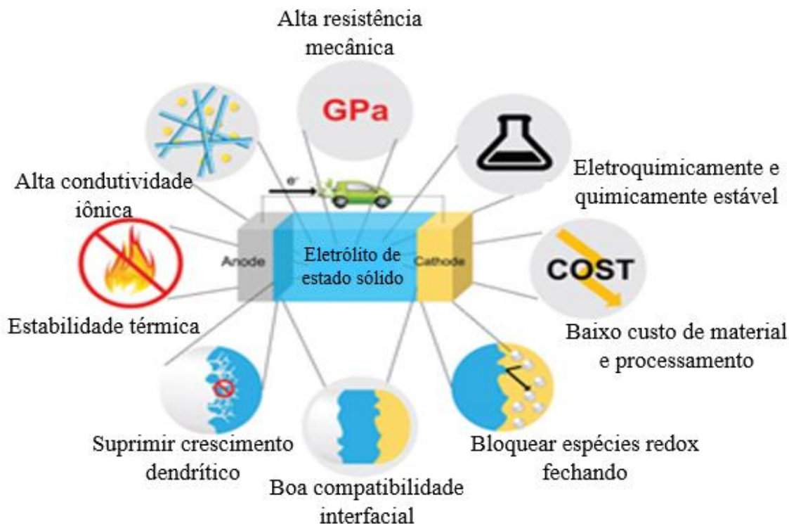
Figura 3 - Requisitos para eletrólitos de estado sólido, seus desafios para utilização em baterias de alta energia
