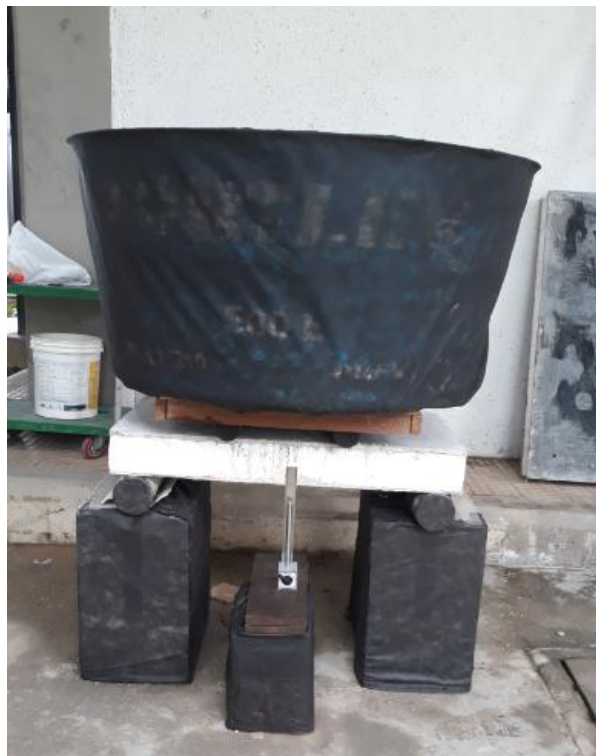
Figura 39 – Ensaio do painel sanduíche a flexão adaptado da norma ASTM C393.
