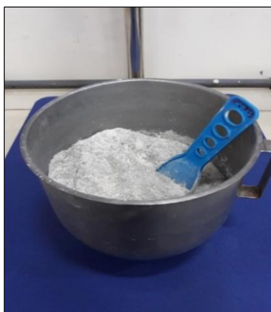
Figura 26 – Homogeneização do material na cuba do misturador.
