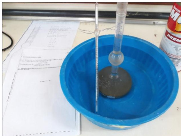
Figura 11 - Ensaio para obtenção da massa específica do cimento.
