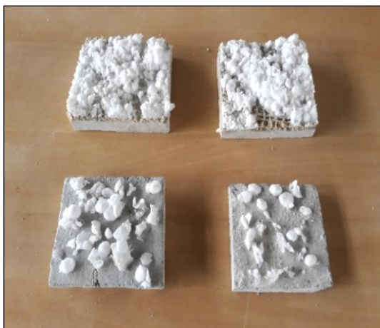
Figura 60 – Análise visual das superfícies dos corpos de prova do ensaio de arrancamento.
