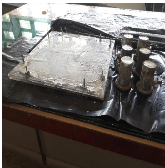
Figura 34 - Conformação da camada final e confecção dos corpos de prova.
