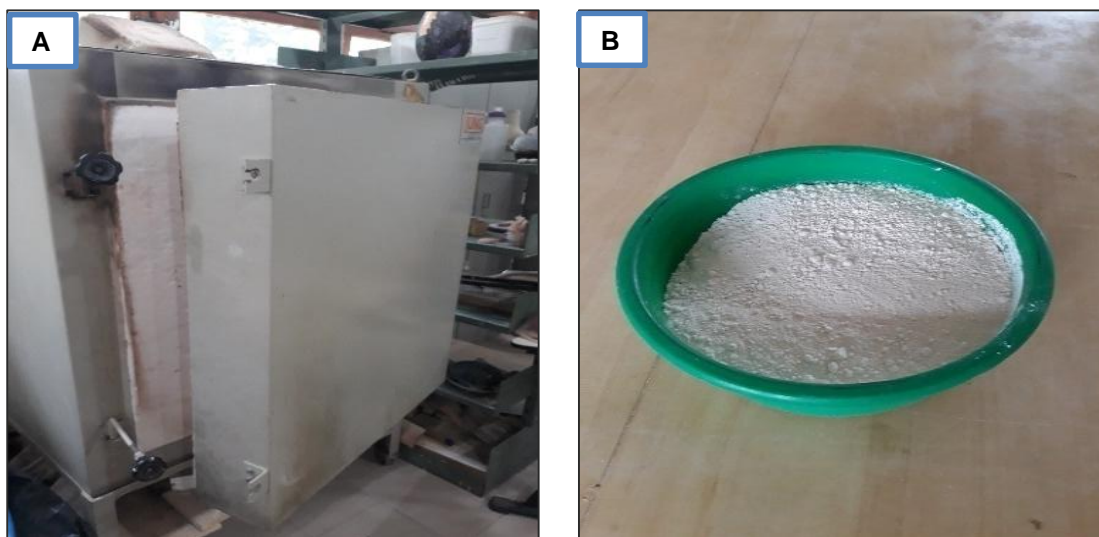
Figura 18 - Processo de produção da metacaulinita, (a) utilização da mufla pelo período de seis horas e (b) Obtenção da metacaulinita após resfriamento.
