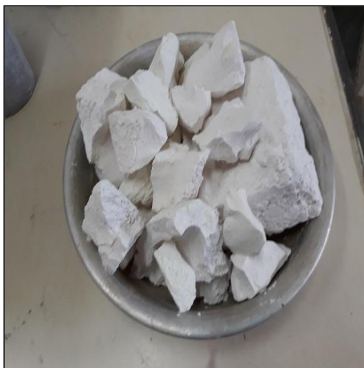
Figura 16 - Retirada do caulim da estufa e maceração do caulim
