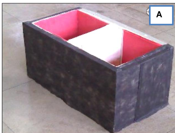
Figura 49 – Equipamento de ensaio acústico, (a) disposição dos acessórios e posicionamento do painel sanduíche na caixa, (b) vedação da caixa para início de ensaio acústico.
