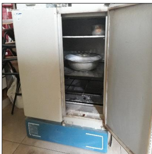
Figura 15 - Processo de produção da metacaulinita, preparo para secagem do material.
