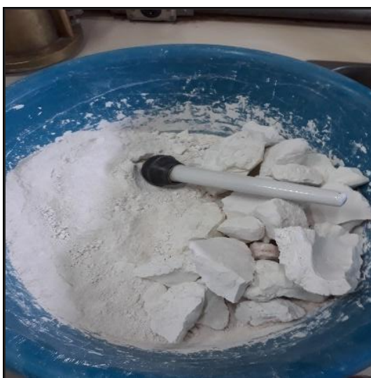
Figura 17 - Maceração do caulim após retirada da estufa.
