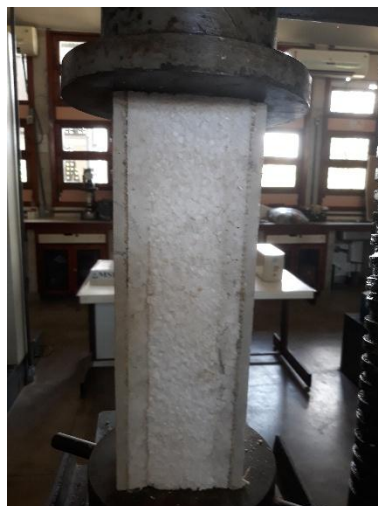
Figura 41 – Configuração padrão de ensaio de compressão adotado pela norma ASTM C364.
