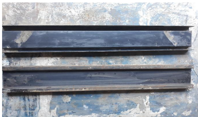
Figura 46 – Formas metálicas para confecção de guias pré-moldadas para moradias populares.
