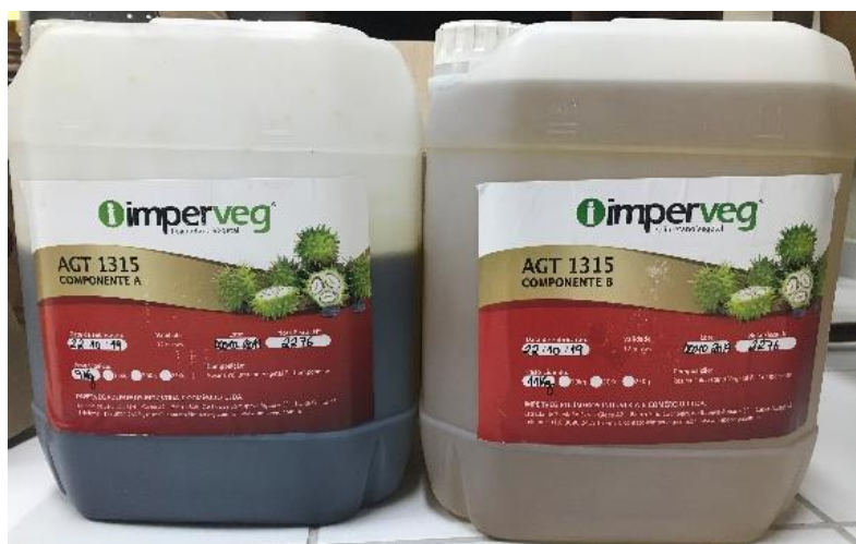
Figura 9. Resina a base de mamona utilizada na confecção dos painéis
