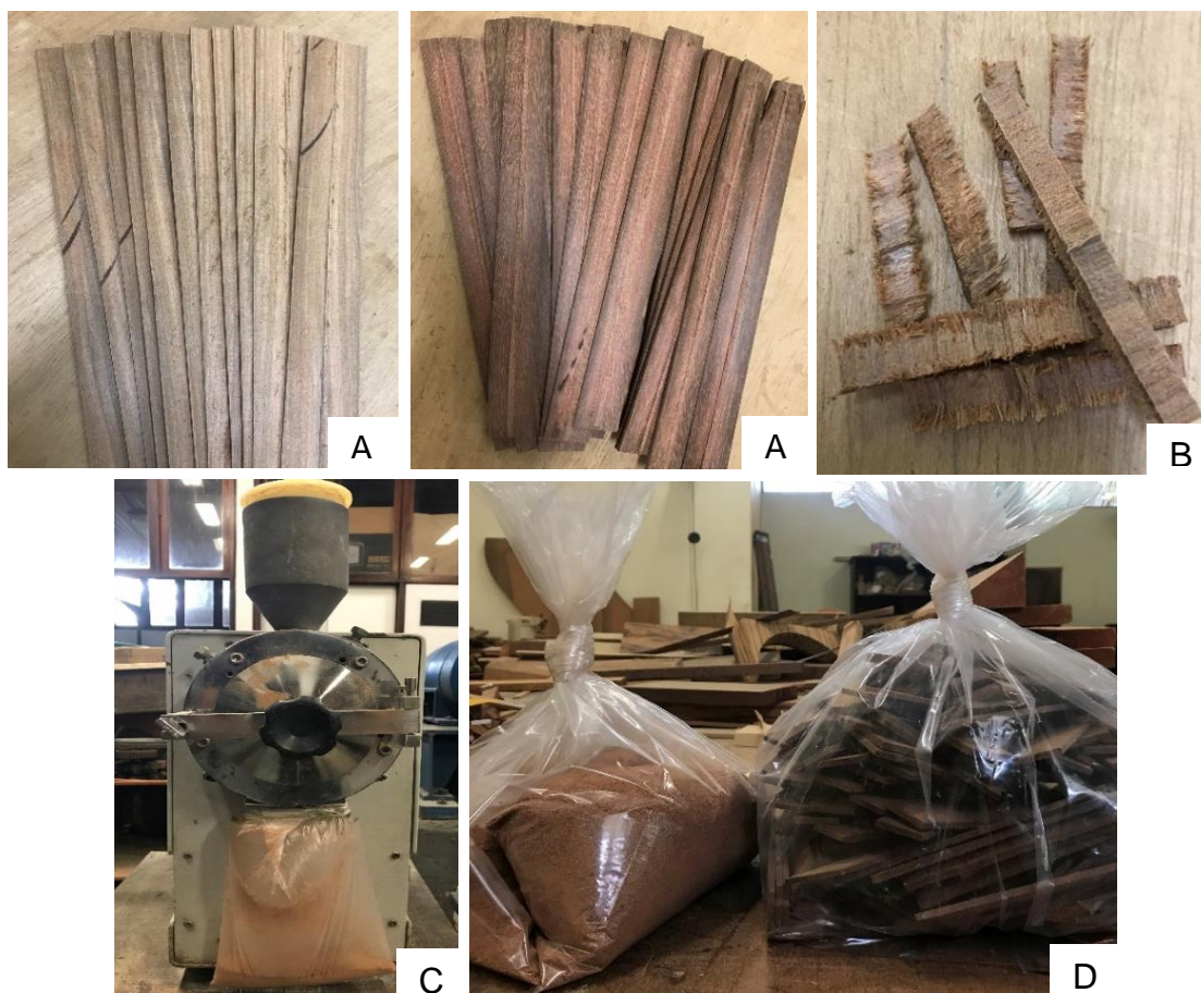
Figura 6. Processo de confecção das partículas de madeira: A) Ripas de Dinizia excelsa Ducke e Manilkara huberi (Ducke) Chevalier; B) Filetes de madeira; C) Trituração dos filetes de madeira em moinho mecânico; D) Partículas e ripas de madeira aguardando o processo de corte em filete.
