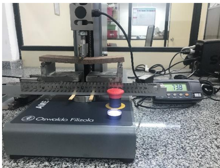
Figura 17. Ensaio de flexão utilizando dispositivo para flexão em 3 pontos na máquina AME – 5kN.
