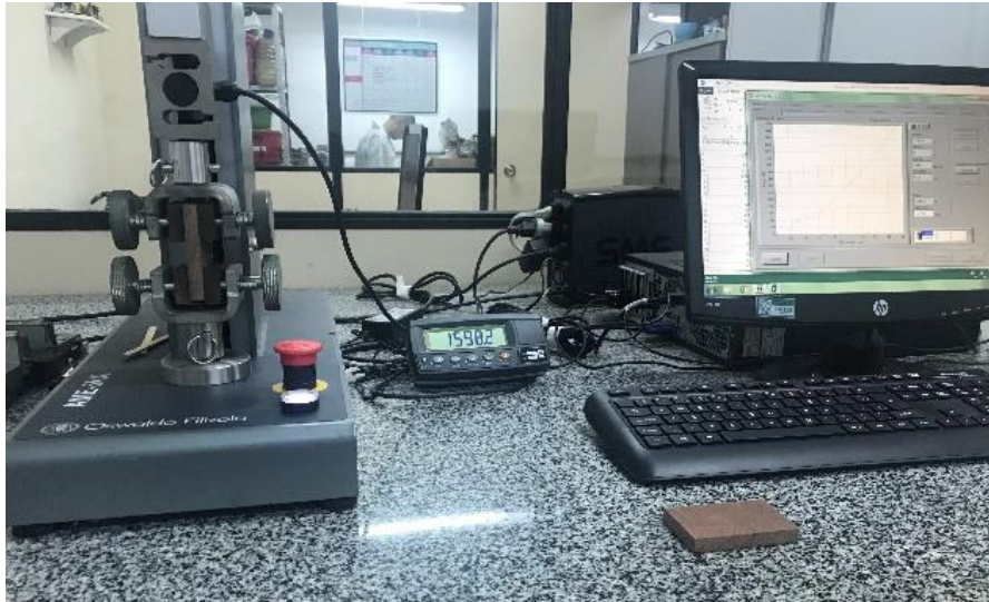
Figura 16. Ensaio de tração utilizando garras de aperto por parafuso na máquina AME – 5kN.
