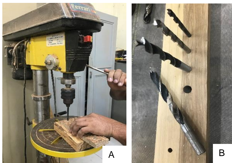
Figura 18. Equipamentos para usinagem de furo: A) Furadeira vertical de bancada marca Ferrari, modelo FC-16; B) Brocas para madeira tendo exceção a broca aço rápido com finalidade para ferro.
