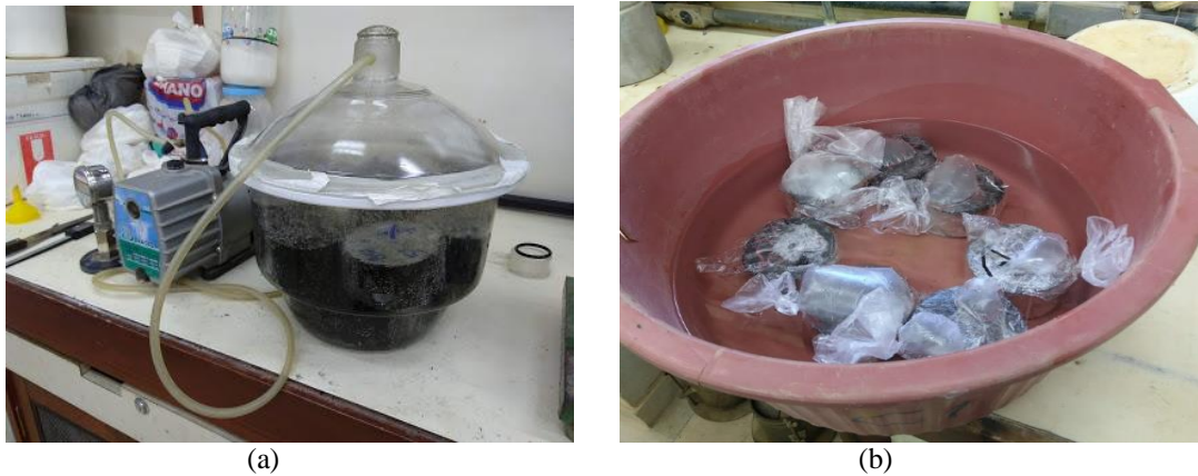
Figura 09 - corpos de provas emergidos em água (b) corpos de provas em pressão de vácuo
