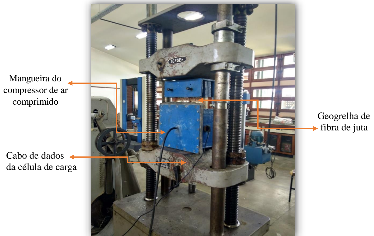
Figura 15 – Tampa com borracha inflável para simular a tensão confinante do solo.
