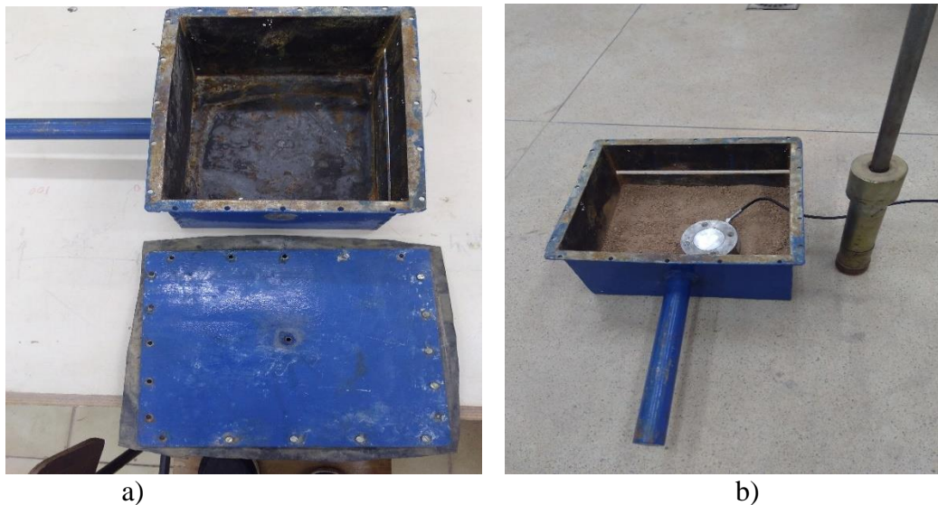
Figura 12 - Equipamento reduzido de laboratório. (a) Caixa metálica de testes de arrancamento. (b) Colocação e compactação de solo na caixa de testes.
