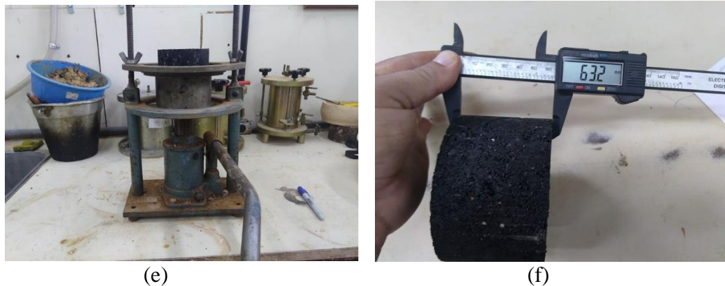
Figura 22 – Etapas para ensaio Marshall no laboratório de pavimentação - UFAM, sendo (a) dosagem ótima para o ensaio; (b) aquecimento do material; (c) prensagem Marshall; (d) Corpos de provas de ensaio Marshall; (e) desforma de corpo de prova de ensaio Marshall; (f) medida de corpo de prova de ensaio Marshall.
