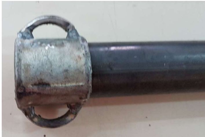
Figura 42 - Alças de engate para guincho manual.
