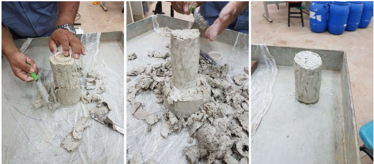
(a) (b) (c) Figura 49 - Moldagem do corpo de prova para ensaio de compressão simples.
