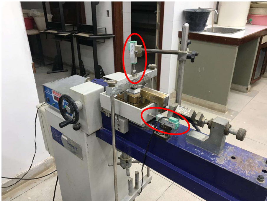
Figura 56 - Posicionamento dos LVDTs e montagem de equipamento pronta para ensaio.
