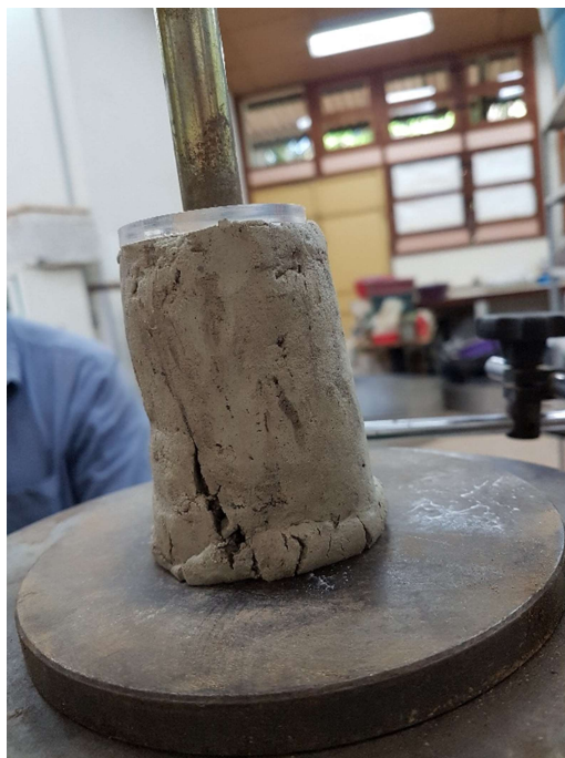
Figura 62 - Corpo de prova do Furo 01 rompido.
