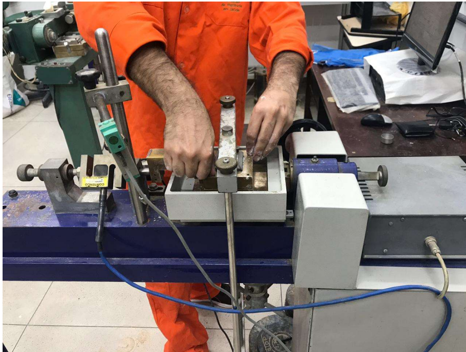
Figura 55 - Posicionamento de aparato para carga tensão normal.
