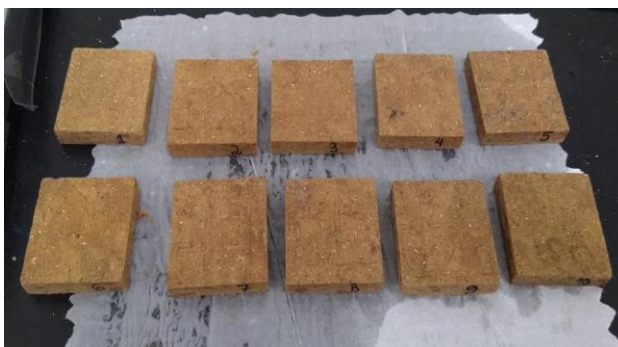
Figura 23-Corpos de prova após o ensaio de absorção de água
