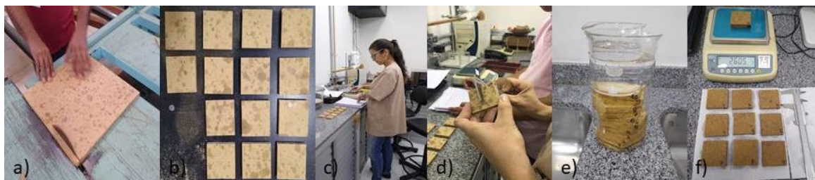
Figura 19- a) esquadrejamento do painel; b) 10 corpos de prova extraídos; c) e d) aferição de peso e medidas; e) ensaio inchamento e absorção; f) aferição medidas após 24h.
