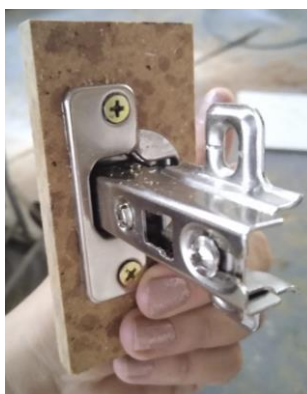
Figura 49-Colocação da dobradiça.
