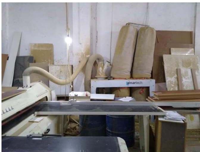
Figura 6- Máquina de corte e sacos de depósito do pó.
