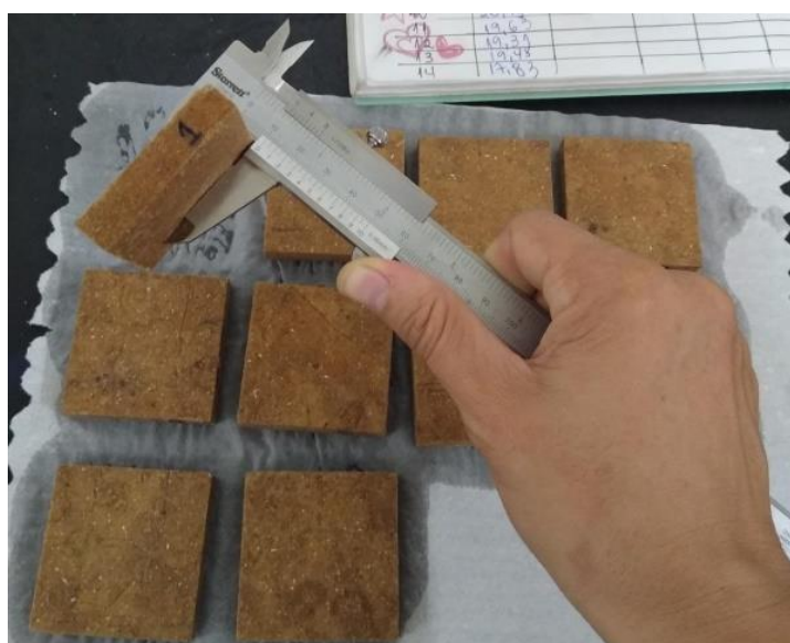
Figura 22-Aferição pós-ensaio inchamento
