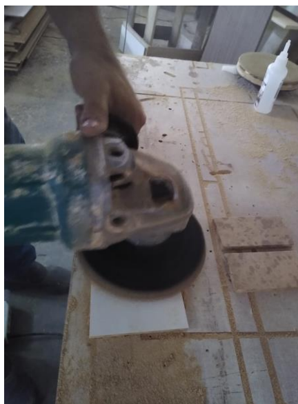
Figura 28-Procedimento de lixamento das amostras
