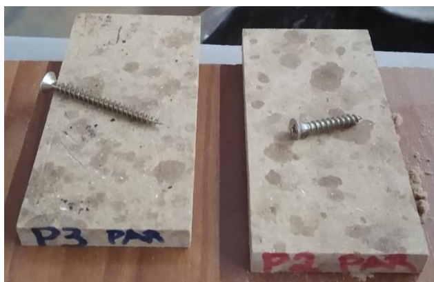
Figura 43- Demarcação para colocação dos parafusos
