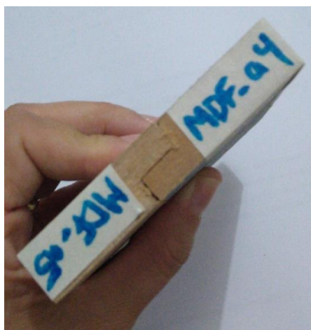
Figura 40-encaixe das amostras MDF
