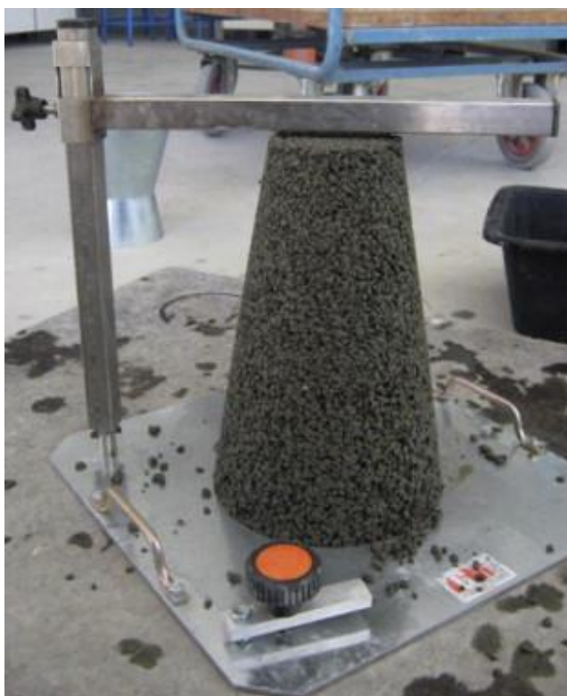
Figura 9: Ensaio de abatimento de tronco de cone em concreto permeável. Fonte: Nguyen, 2014.
