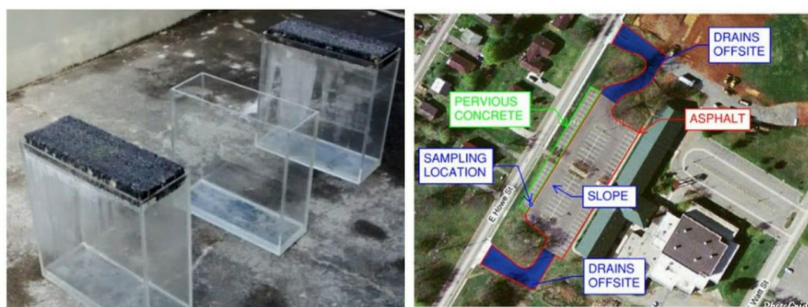
Figura 17: Avaliação de pavimentos permeáveis a) Caixas e lajes expostas à chuva; b) Estacionamento do Alcoa City Center
