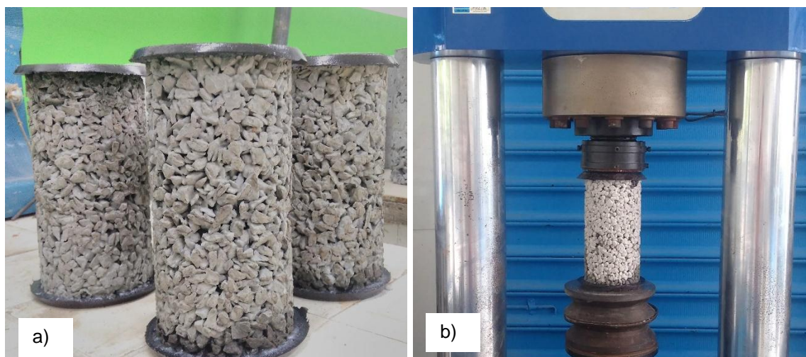
Figura 33: Compressão Simples a) Nivelamento das amostra com enxofre; b) Ensaio de resistência à compressão simples.
