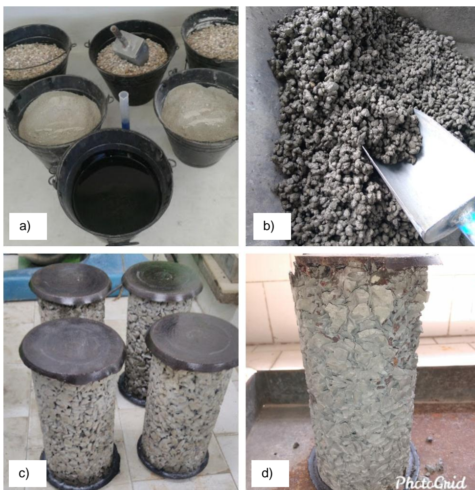
Figura 29: Etapas da preparação das amostras a) Material utilizado; b) Mistura de concreto permeável; c) CP capeados para ensaio de resistência à compressão; d) CP rompido a compressão. Fonte: Autor, 2019.
