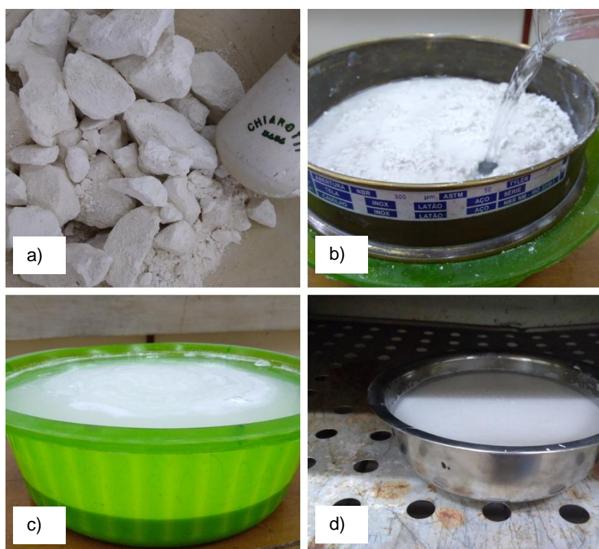
Figura 27: Tratamento do caulim. a) destorroamento; b) lavagem e peneiramento; c) sedimentação e; secagem em estufa.
