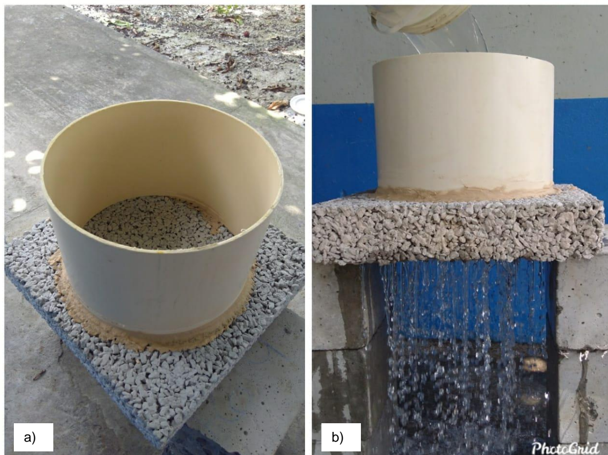
Figura 36: Ensaio para medição do coeficiente de permeabilidade.
