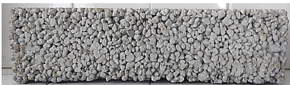
Figura 32: Viga de concreto permeável. Fonte: Autor, 2019.
