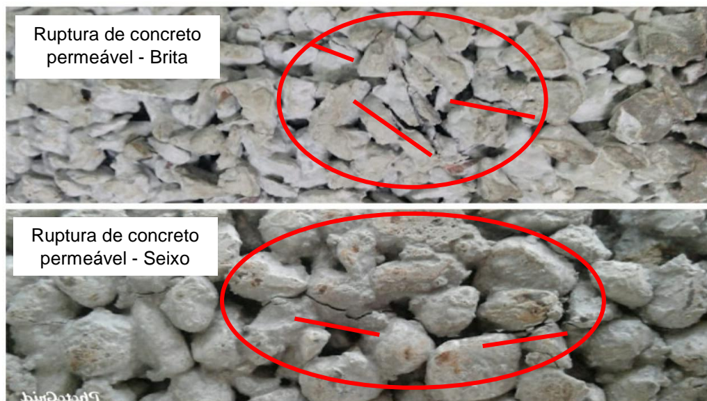
Figura 34: Fissuras constatadas após ruptura na compressão.
