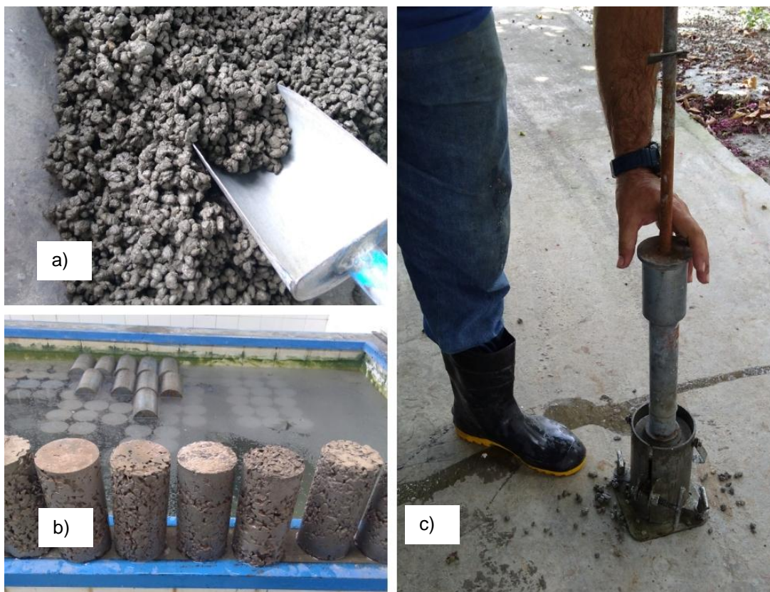
Figura 31: Compactação, acabamento e cura de amostras de concreto permeável. Fonte: Autor, 2019.
