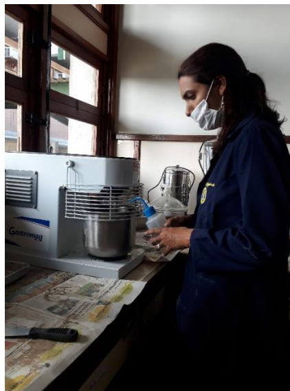
Figura 17: Homogeneização da mistura com 50% da água da mistura
