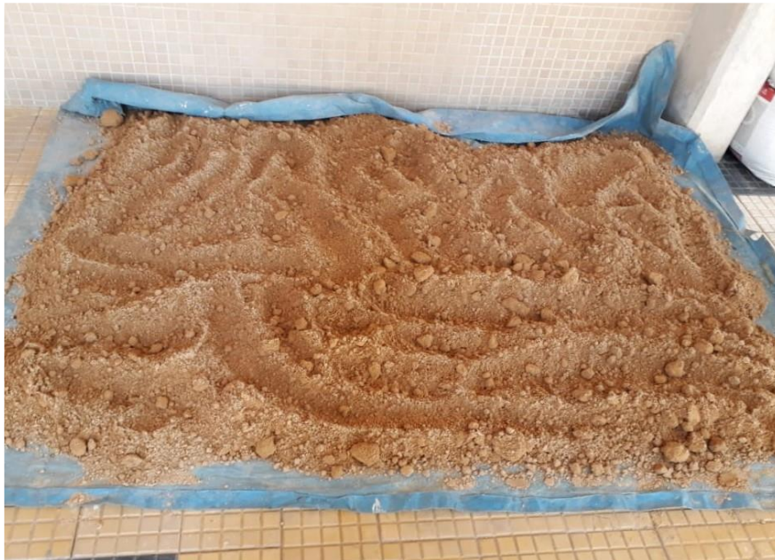
Figura 8: Secagem prévia das amostras
