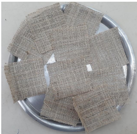
Figura 12: Amostras utilizadas para o ensaio de absorção das fibras
