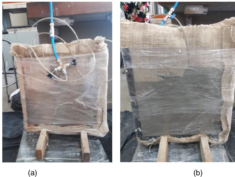
Figura 20: Esquemas de moldagem das placas com 4 tecidos de reforço: a) Sistema de mangueiras com 5 saídas; b) Preenchimento da placa com a argamassa
