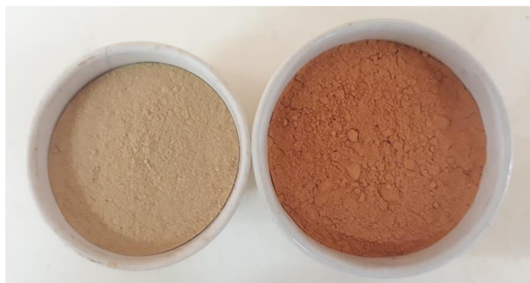
Figura 9: Amostras de solo antes e após a calcinação
