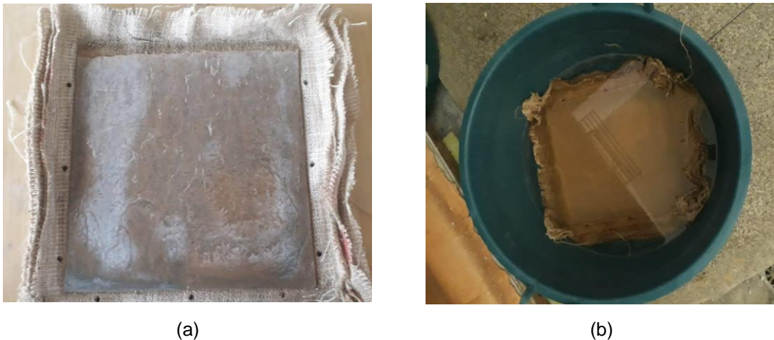
Figura 21: a) Placa desmoldada após 24 horas; b) Placa em cura úmida
