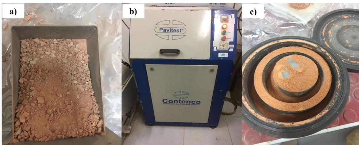
Figura 12 - Processos de beneficiamento dos resíduos cerâmicos: a) Material seco; b) Resíduo após a moagem; c) Peneiramento manual
