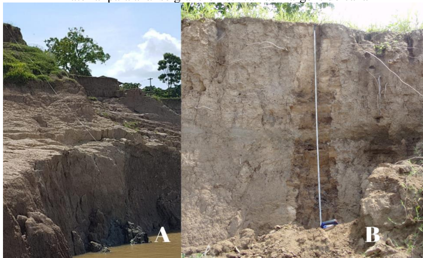
Figura 11 - Perfis das margens: margem esquerda (A) e margem direita (B) e de coleta de material para análise granulométrica nas margens do canal
