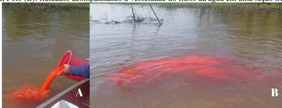
Figura 9 - Teste de velocidade do fluxo da corrente com o uso de corante. Foto (A): Despejo do corante no canal; Foto (B): flutuador acompanhando a velocidade do fluxo da água em uma seção transversal.
