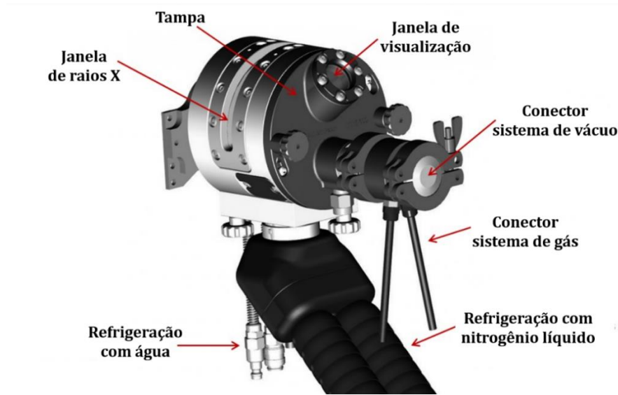
Figura 2.18 – Principais componentes de uma câmara de aquecimento de DRX em alta temperatura [67].
