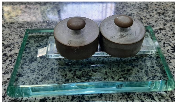
Figura 20 Conjunto matriz, placas de vidro, tiras de poliéster e pesos prontos para serem levados a estufa
