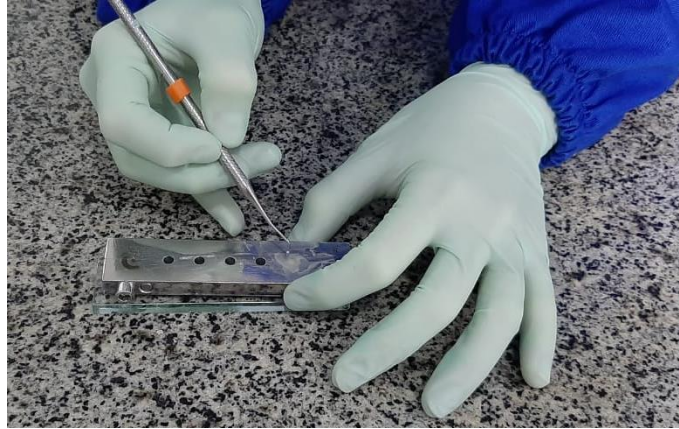
Figura 19 Inserção na matriz com auxílio de calcadores
