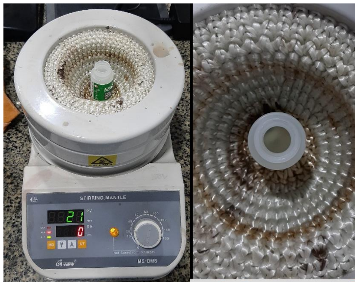
Figura 16 Manta aquecedora com o líquido e barra magnética de teflon agitando o líquido
