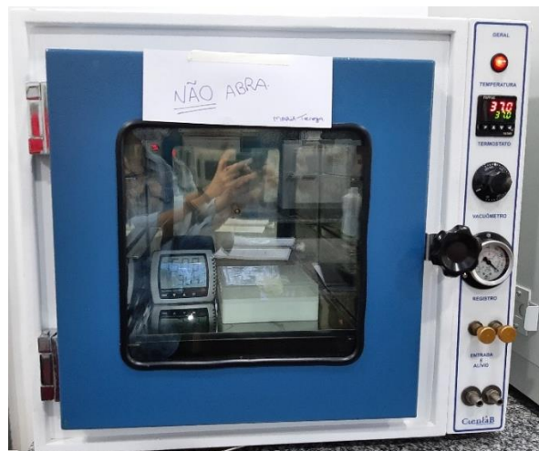
Figura 23 Estufa com o higrômetro e os ependorffs contendo os corpos de prova
