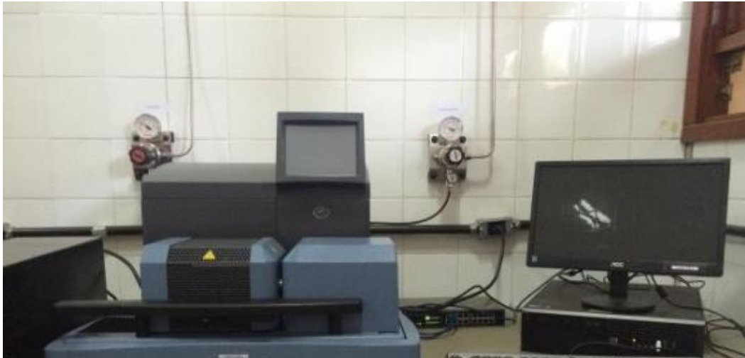
Figura 15 - Equipamento termogravimetria modelo SDT Q600 Simultâneo da TA Instruments
