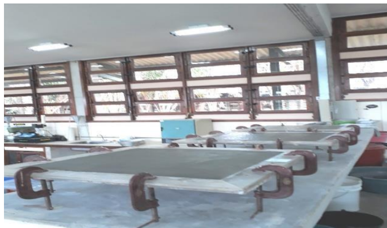
Figura 21 – Placas moldadas em formas quadradas
