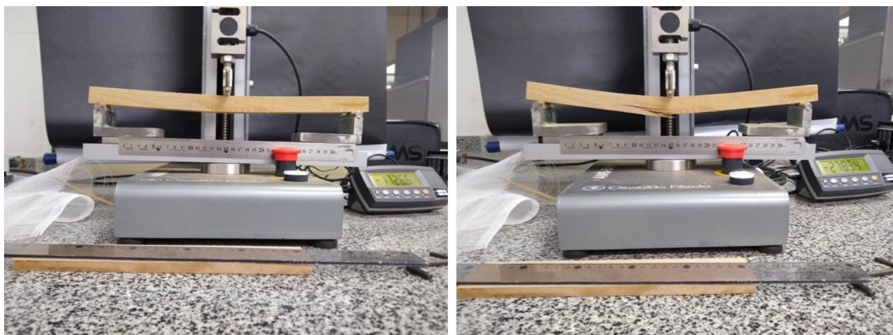
Figura 6. Corpo de prova submetido ao ensaio físico de flexão estática
