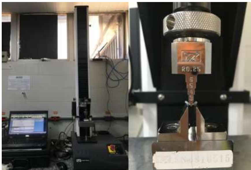
Figura 10. Máquina de teste universal (INSTRON com Laptop Dell Latitude E5510).
