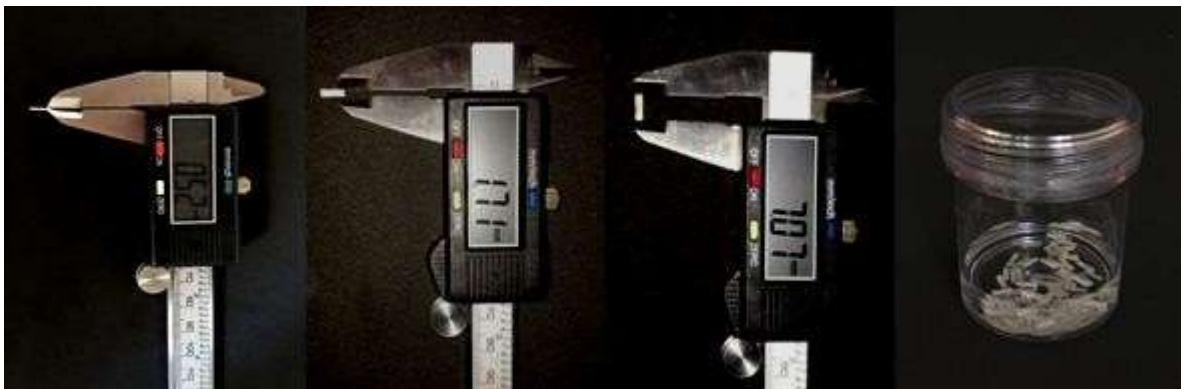
Figura 6. Corpos de prova preparados através do corte, com dimensão retangular padrão final de 0,5mm de espessura x 1,7 mm de altura x 7 mm de comprimento, armazenados em água destilada.
