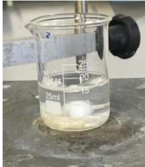
Figura 7. Imersão dos corpos de prova em solução de ácido fosfórico 10%, sob agitação.
