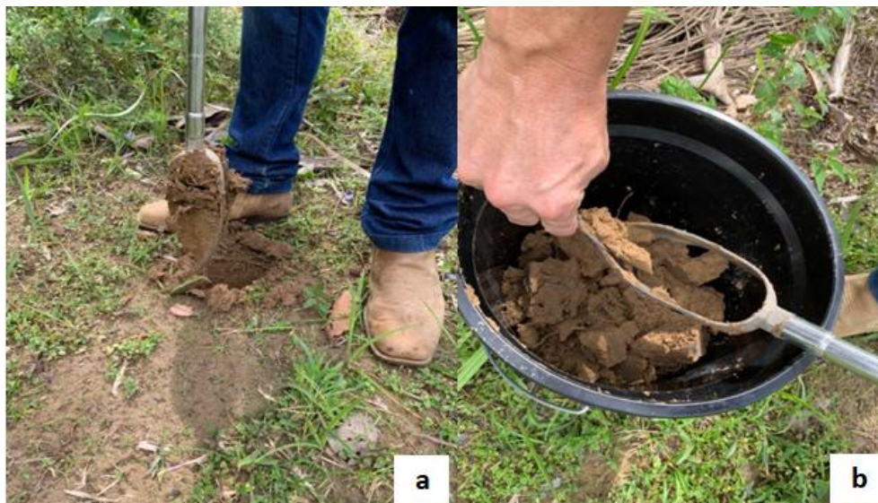
Figura 4 - a) forma de realização do furo no solo para coleta de amostras de solo. / b) retirada do solo do trado e acomodação em balde utilizado para homogeneização das amostras simples e formação da amostra composta.
