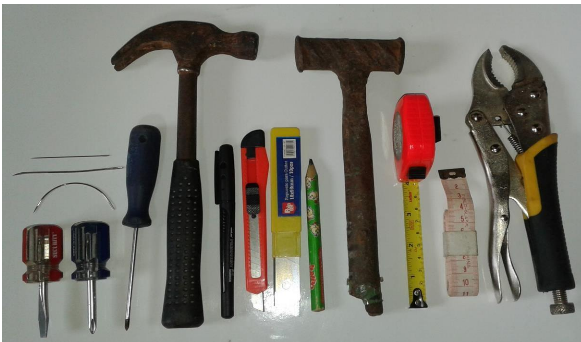
Fig. 37 - Materiais usados pela autora para produção de paramentas rústicas e de alumínio. Da esquerda para direita: agulhas de costura curva, de tapeceiro, de lã; chaves philips cotoco de 1/8" e 3/16"; chave philips de 1/4"; martelo de unha com cabo emborrachado 18mm; caneta pincel ponta grossa; estiletes de lâmina fina e grossa; lápis triangular 8B; martelo artesanal de duas cabeças; trena; fita métrica; alicate de pressão. Foto da autora, abr/2019.
