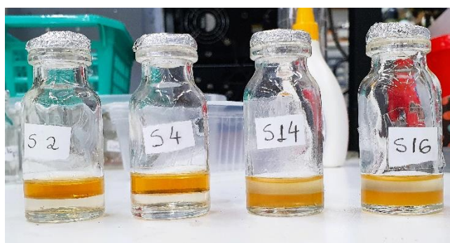
FIGURA 16. Realização dos testes de sistemas de solventes em frascos. Equilíbrio do soluto entre as duas fases dos sistemas 2, 4, 14 e 16.
