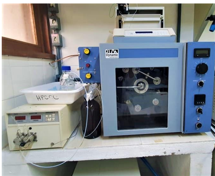
Figura 18. Cromatógrafo de contracorrente de alta performance “ High Performance Countercurrent Chromatography (HPCCC), localizado Laboratório de Química de Produtos Naturais (ICE-UFAM). Fonte: Sarah Flores, 2020.
