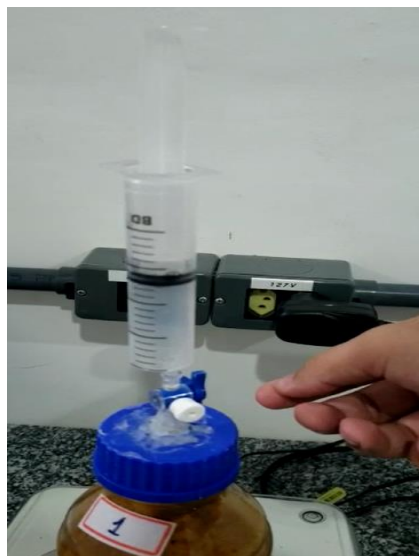
Figura 9. Processo de ventilação do gás produzido. Fonte: Alencar, 2022.
