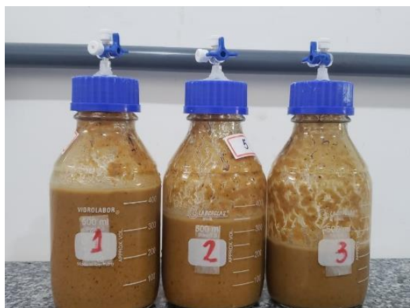
Figura 7. Amostras 01, 02 e 03 com diferentes headspace do experimento. Fonte: Alencar, 2022.
